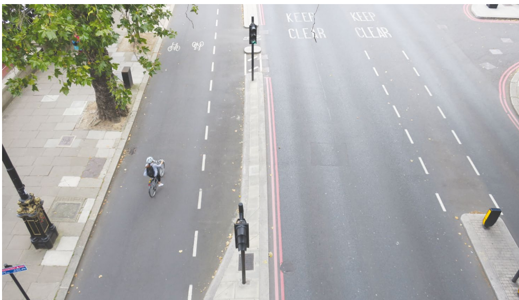
Rycina 36. Droga dla rowerów wydzielona z jezdni bez konieczności zwężenia chodnika, z połączeniem z drogą poprzeczną na skrzyżowaniu z sygnalizacją świetlną
