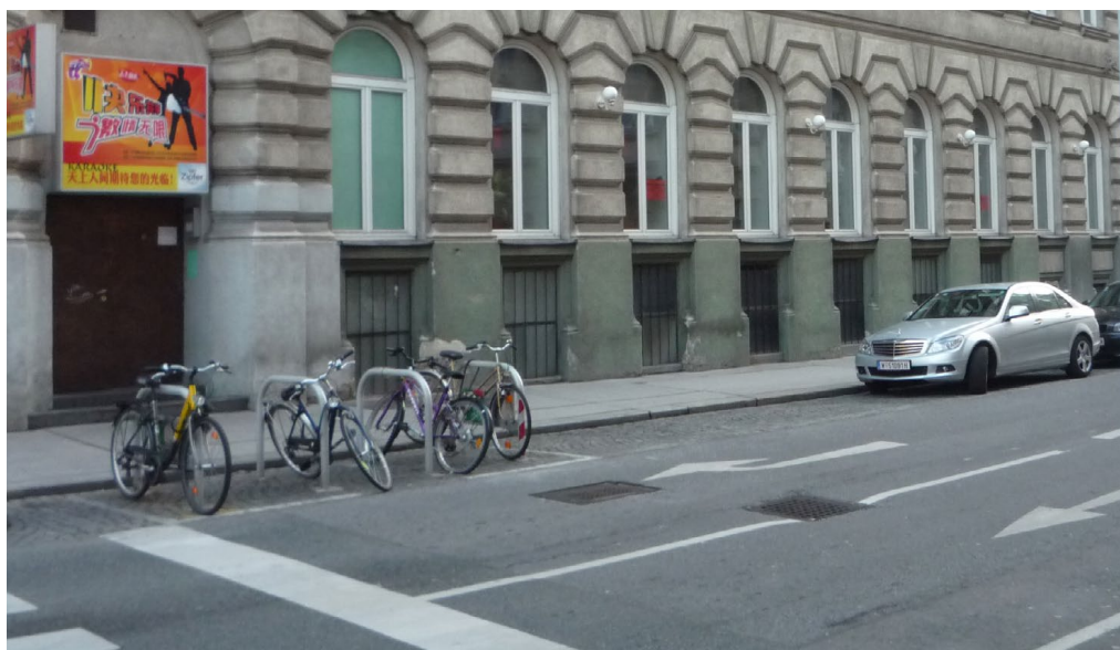
Rycina 74. Stojaki rowerowe na powierzchni wyłączanej z ruchu przed skrzyżowaniem, dostępne z jezdni i pełniące funkcję urządzeń bezpieczeństwa ruchu drogowego, uniemożliwiając parkowanie samochodów przed przejściem dla pieszych
