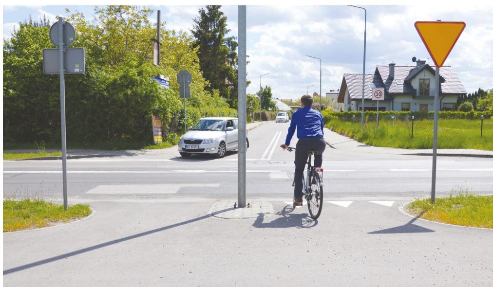
Rycina 48. Przykład prawidłowego połączenia drogi dla rowerów z prostopadłą jezdnią na skrzyżowaniu trójramiennym
