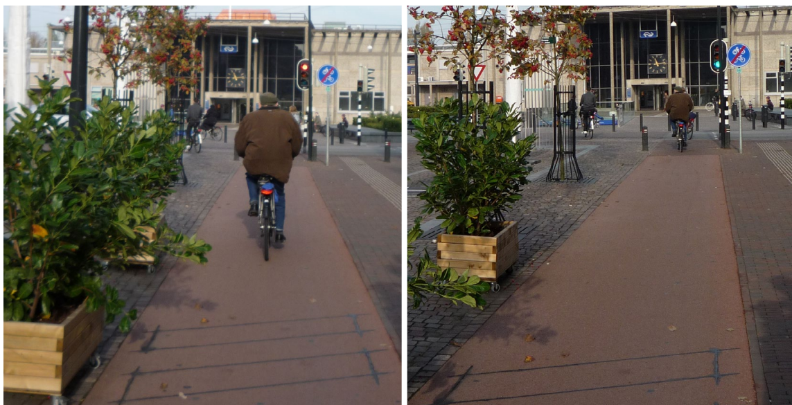
Rycina 60. Automatyczna detekcja rowerzysty przed skrzyżowaniem, zwiększająca szanse na zielone światło w momencie dojazdu na do skrzyżowania
