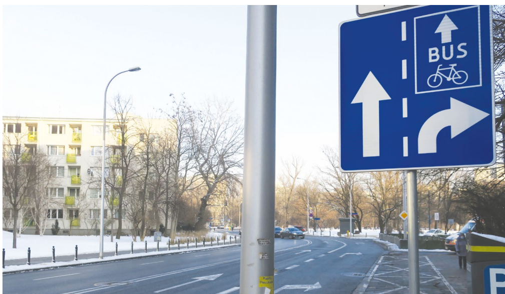
Rycina 28. Dopuszczenie jazdy rowerem na wprost z pasa do skrętu w prawo
