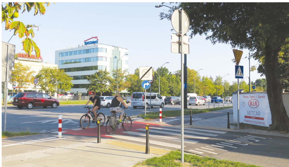
Rycina 7. Ilustracja bezpieczeństwa tras rowerowych – przejazd roweru poprowadzony grzbietem progu zwalniającego w strefie „Tempo 30 km/h”
