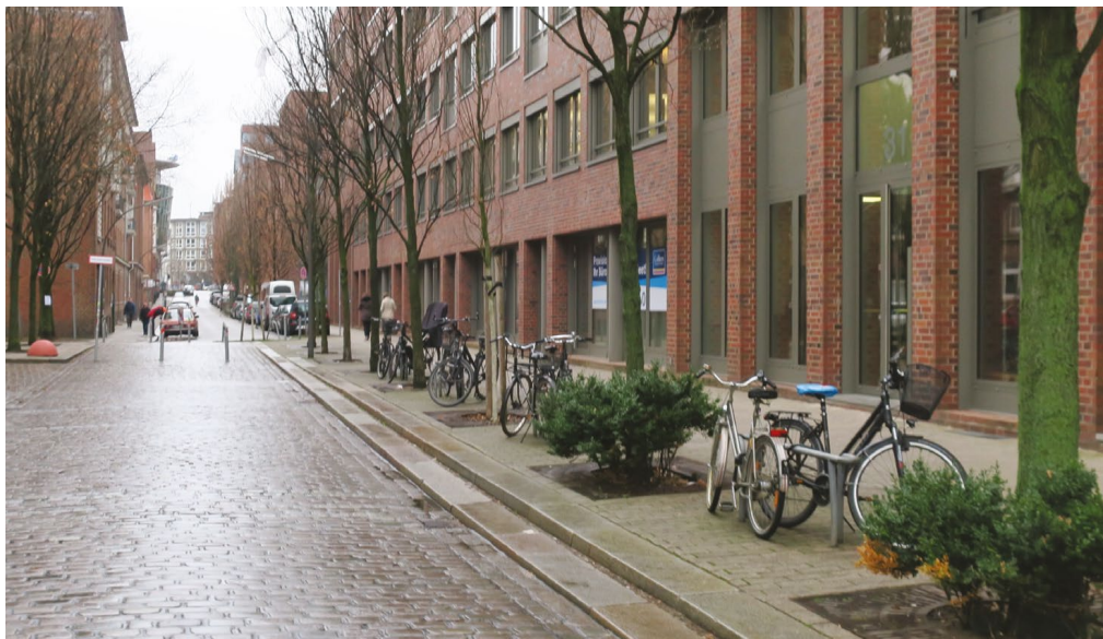
Rycina 76. Stojaki rowerowe prawidłowo umieszczone w linii szpaleru drzew, nie ograniczające szerokości użytkowej chodnika – w głębi droga przejezdna na wprost tylko dla rowerów (por. pkt 7.4.1)
