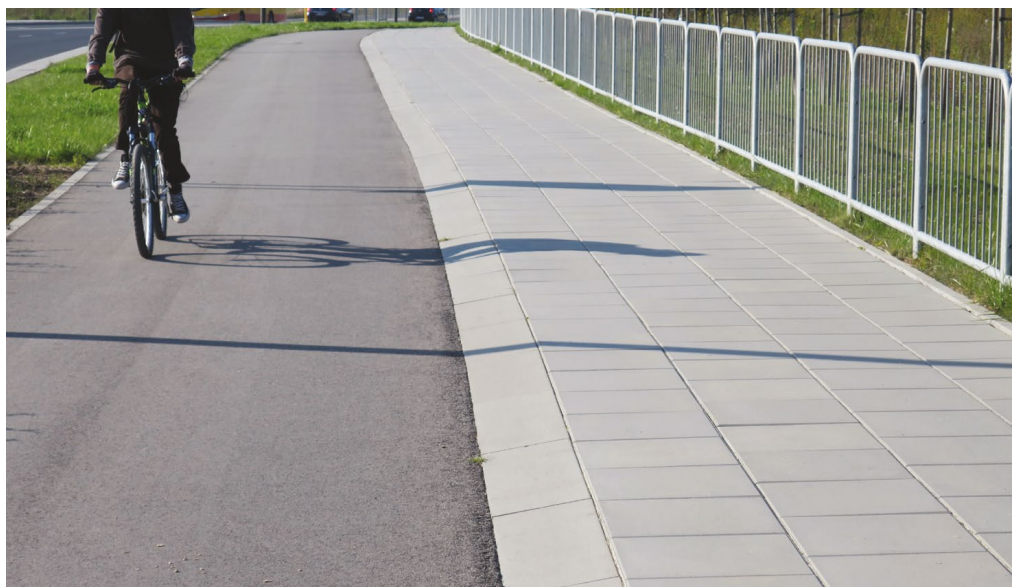
Rycina 39. Prawidłowe rozdzielanie chodnika i drogi dla rowerów
