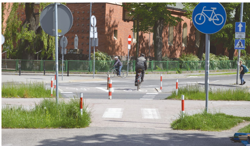
Rycina 5. Ilustracja spójności tras rowerowych – droga rowerowa połączona z ulicami z dwukierunkowym ruchem rowerowym
