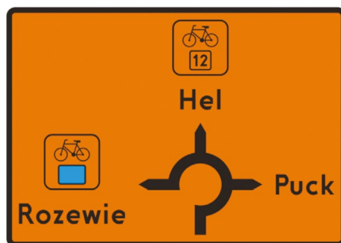
Rycina 71. Znak R-4e (tablica przeddrogowskazowa) – w relacji na wprost trasa krajowa, w relacji na lewo trasa lokalna
