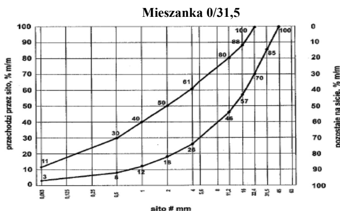
Rys. 1. Uziarnienie mieszanki CBGM 0/31,5
