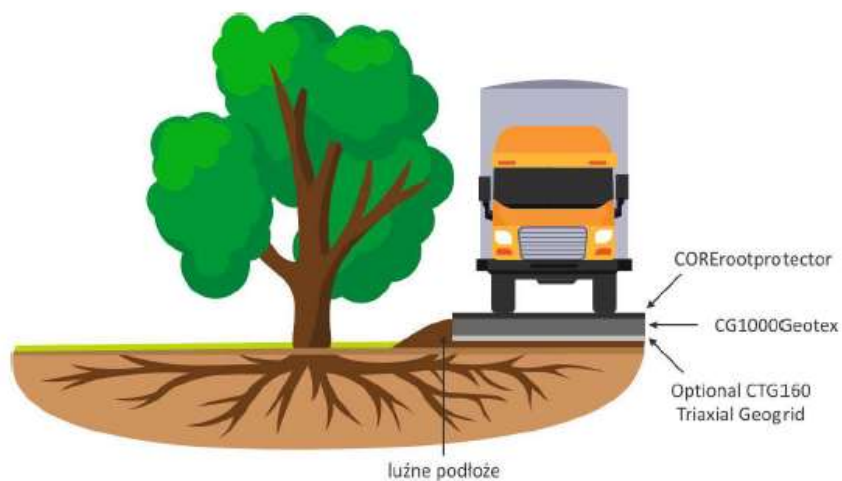
Rys. 38 Droga tymczasowa z nawierzchnią (geokraty lub płyty betonowe) dla krótkotrwałego i długotrwałego ruchu ciężkiego sprzętu o masie do 30 t – opracowanie własne [59]
