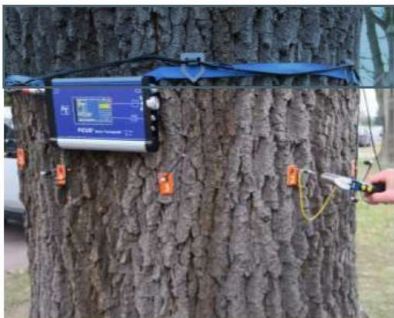
Fot. 2 Badanie bezinwazyjne budowy wewnętrznej drzewa tomografem akustycznym i jego wynik – tomogram
