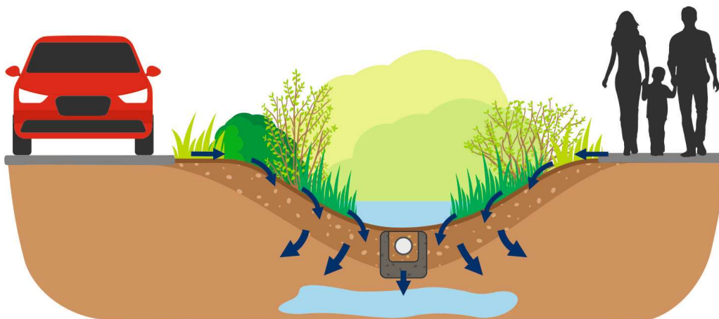
Rys. 23 Schemat przepływu wody deszczowej przez rów wegetacyjny - opracowanie własne [41]
