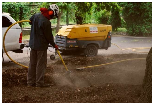
Fot. 47 Przykład zastosowania narzędzia Air Spade [60]
