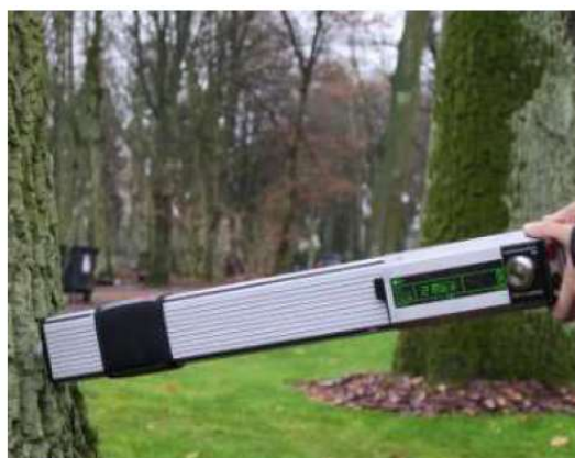
Fot. 3 Badanie budowy wewnętrznej drzewa rezystografem i jego wynik – dendrogram
