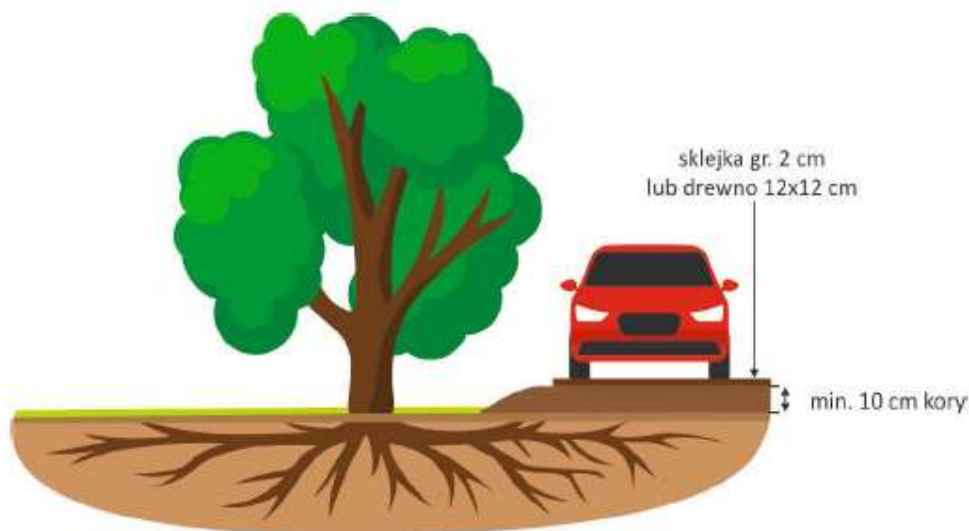
Rys. 34 Droga tymczasowa (do 3 miesięcy) dla pieszych i krótkotrwałego ruchu pojazdów o masie do 3,5 t - opracowanie własne [59]
