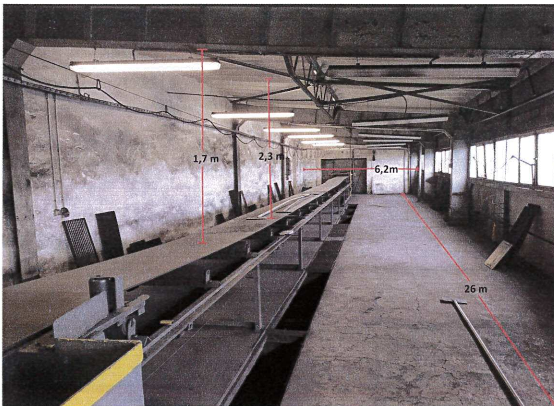
Rys. 1. Hala nawęglania z naniesionymi wymiarami.
