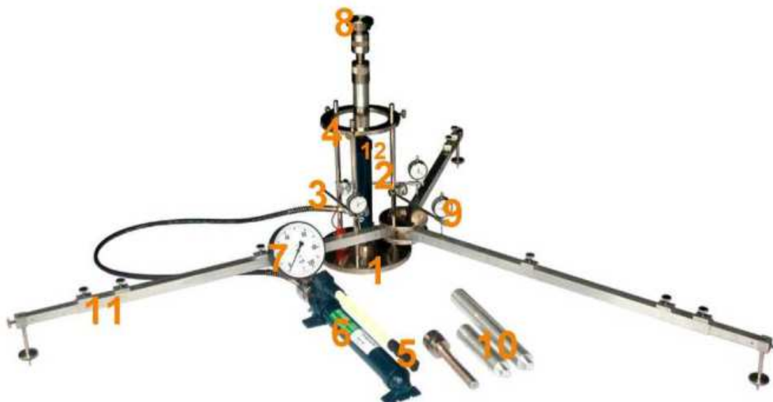
Rys. 1.1. Aparatura VSS z trzypunktowym pomiarem przemieszczenia płyty
