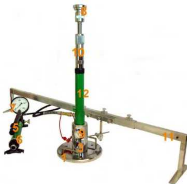
Rys. 1.2 Aparatura VSS z jednopunktowym pomiarem przemieszczenia płyty
