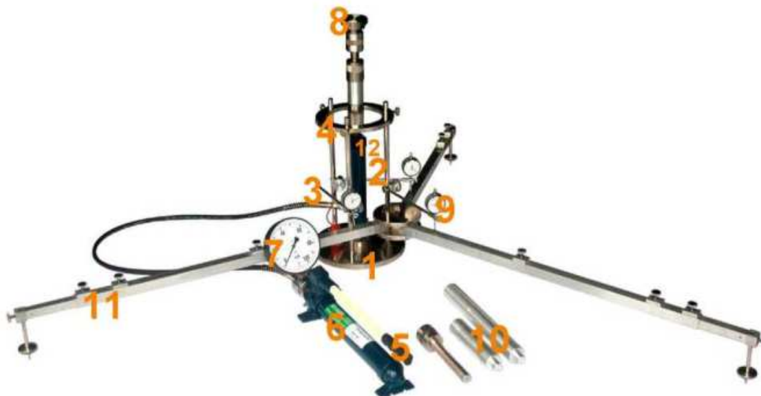
Rys. 1.1. Aparatura VSS z trzypunktowym pomiarem przemieszczenia płyty
