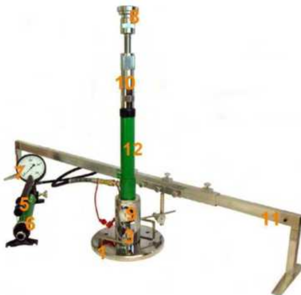
Rys. 1.2 Aparatura VSS z jednopunktowym pomiarem przemieszczenia płyty
