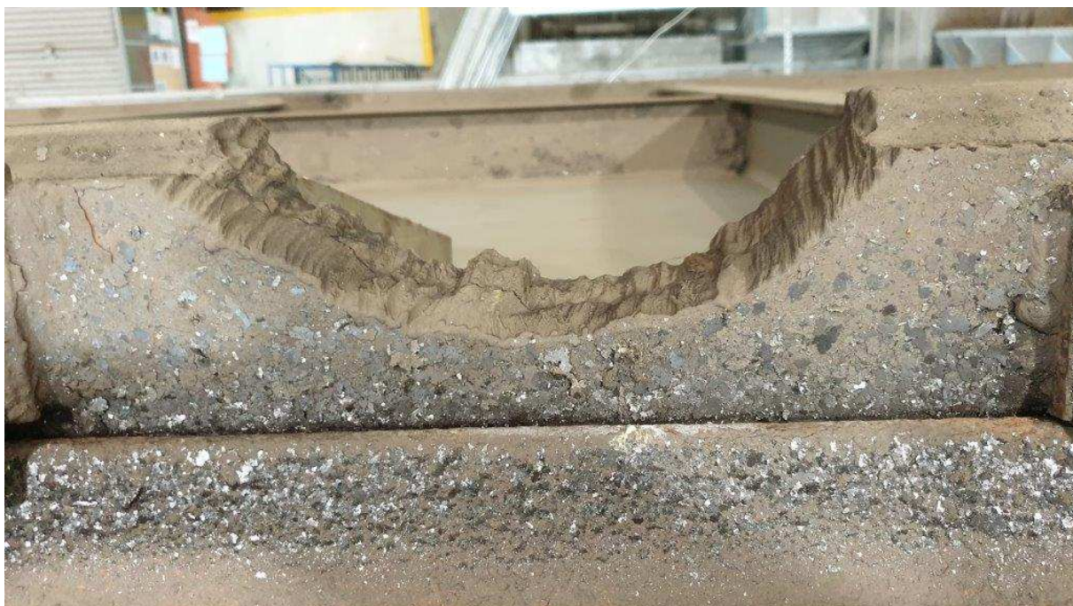
Fot.21. Jak na fot.20. Zbliżenie. Widoczne ślady cięcia palnikiem.
