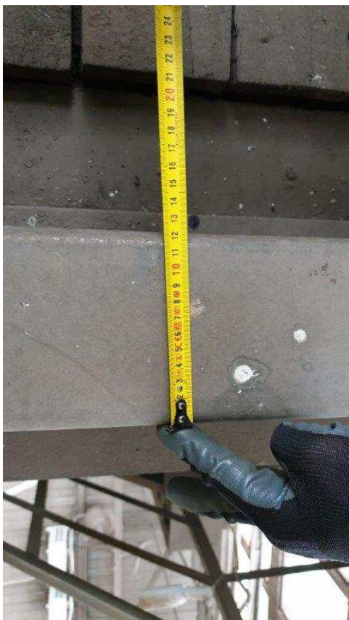
Fot.9. Inwentaryzacja szerokości istniejącej szyny w hali B1 nawa 10. Szyna SP 120.
