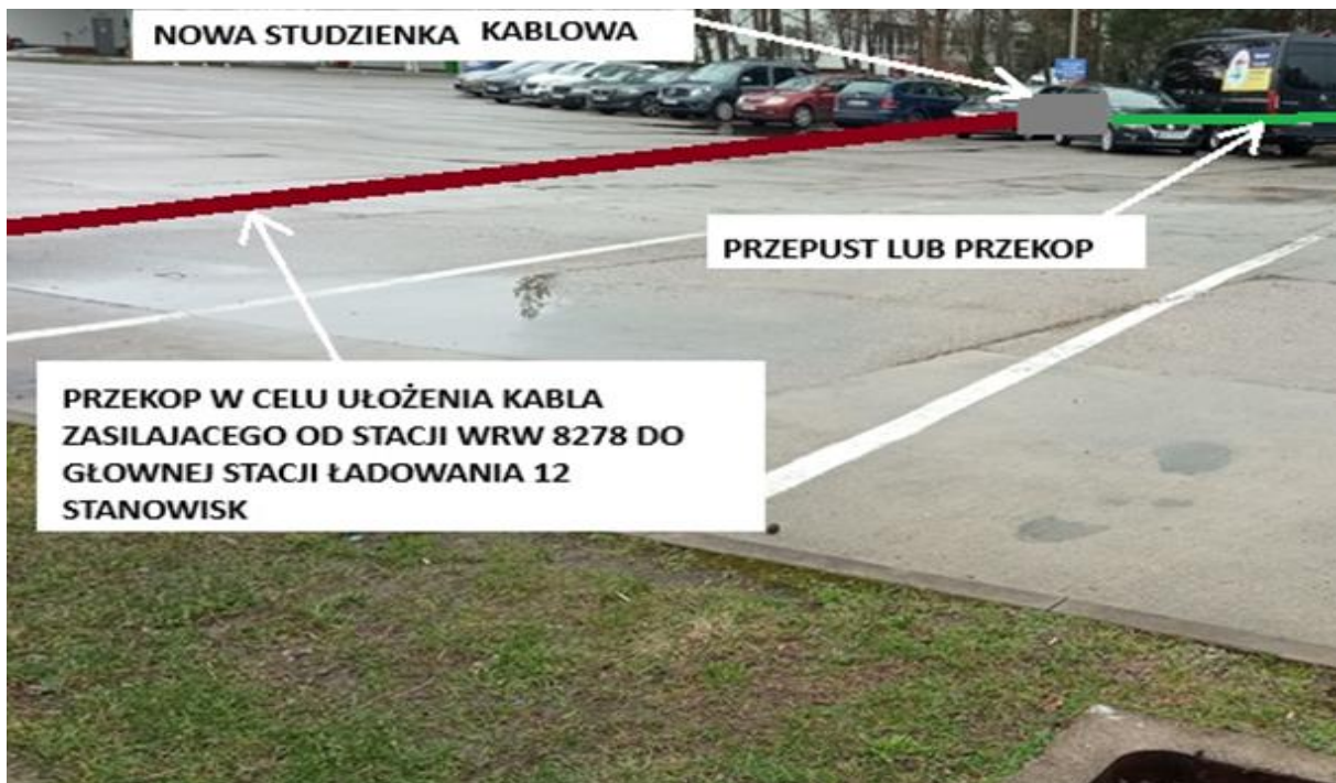
RYСУNEK .LOKALIZACJA PRZEPUSTU -TRASY KABLOWEJ
