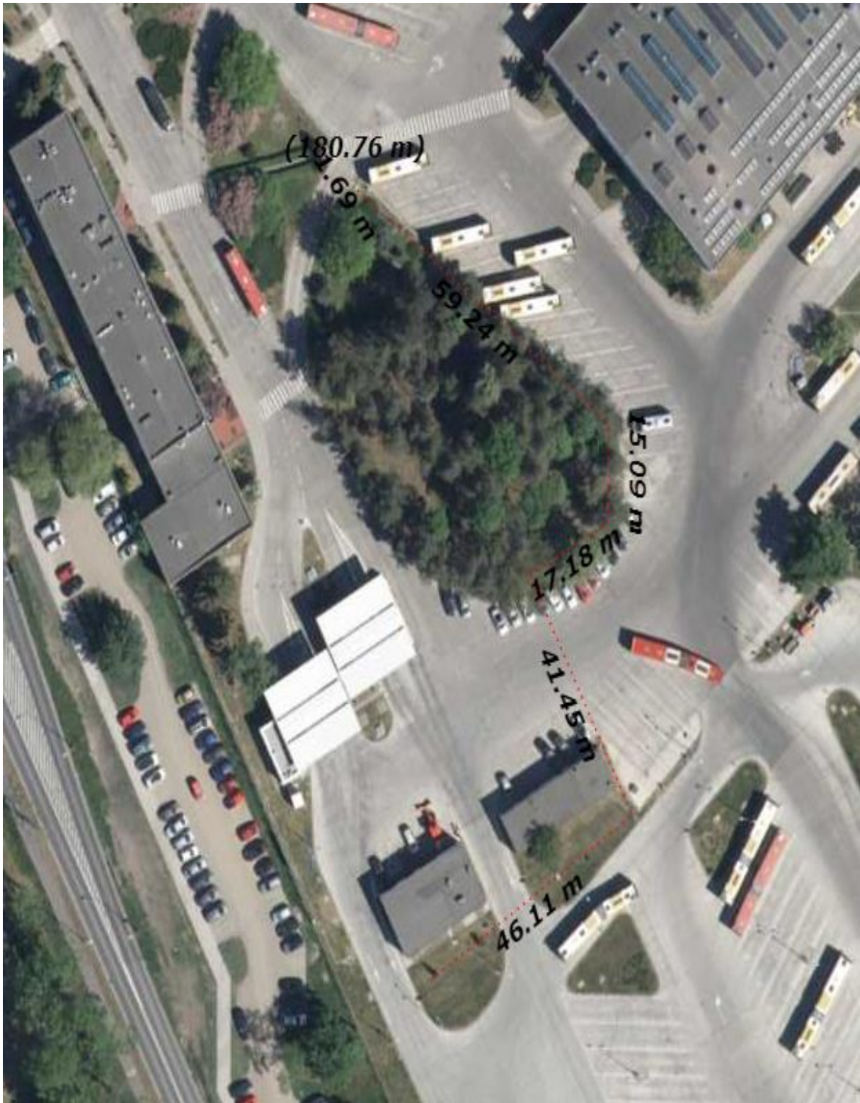
RYSUNEK . TRASA KABLOWA DLA ZASILANIA 6 sztuk ZK .MOC POJEDYNCZEGO ZŁACZA 120 kW
