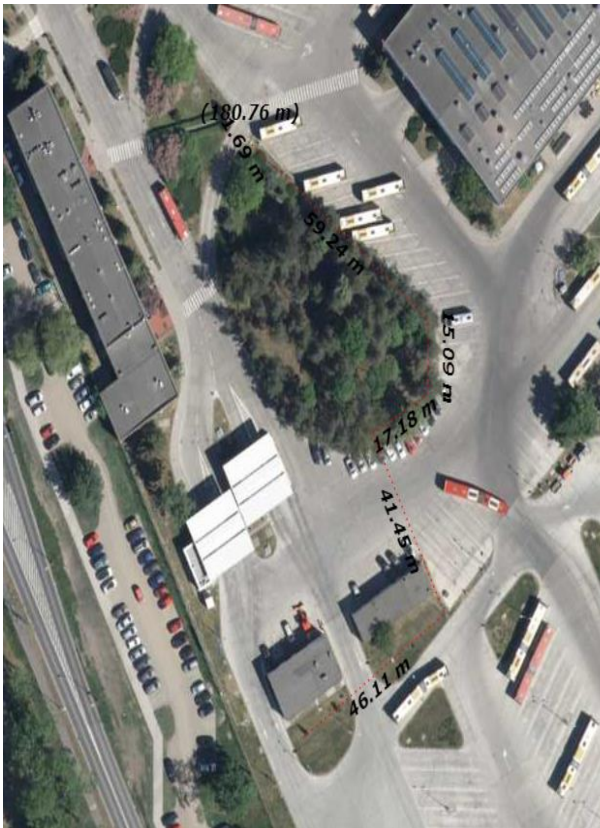
RYSunEK . TRASA KAbLOWA DLA ZASILANIA 6 sztuk ZK .MOC POJEDYNCZEGO ZŁACZA 120 kW
