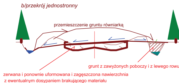
Rys. 12.7. Przebudowa drogi wg karty technologicznej nr 4
