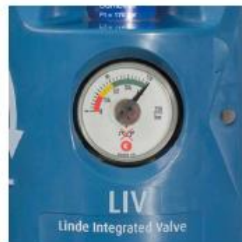
Manometr – wskazuje poziom napełnienia gazem
