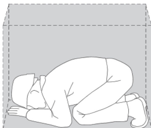
Rys. 10: Przestrzeń bezpieczeństwa w podszyciu (wysokość 700 mm)
