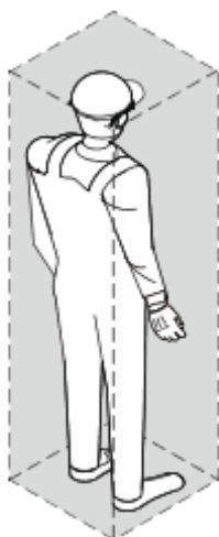
Rys. 14: : Przestrzeń bezpieczeństwa w nadszybiu (wysokość 2000 mm)
