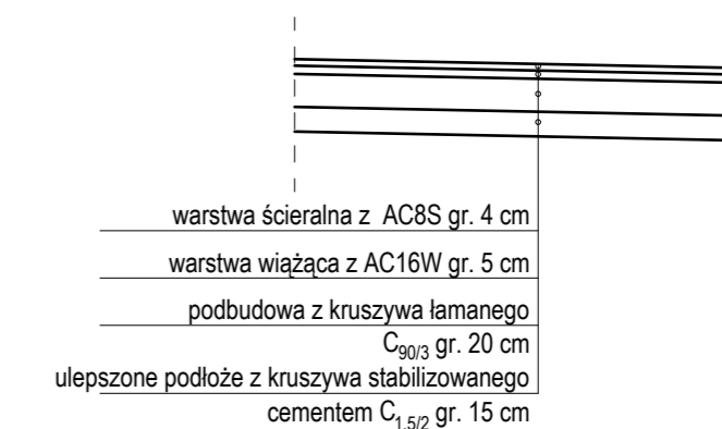
Przekrój konstrukcyjny zjazdów polnych bitumicznych
