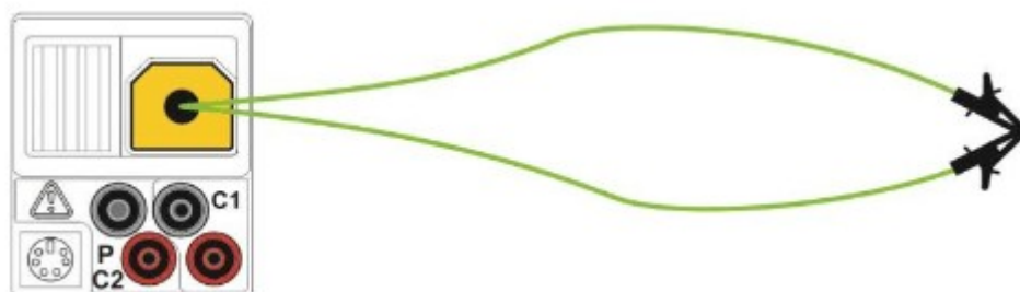
Przykładowe połączenie przewodów pomiarowych do kompensacji ich rezystancji
