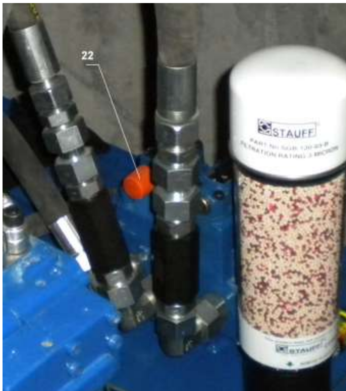
I.2.6_Blok zaworowy II z zaworem ciśnieniowym (22)
