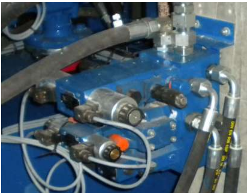
I.2.4_Blok zaworowy IB filar F2/G
