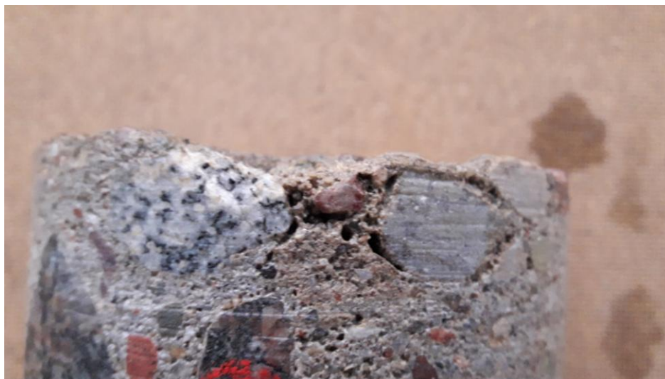
Fot.3: Przykładowe uszkodzenia betonu przypowierzchniowe łuku środkowego
