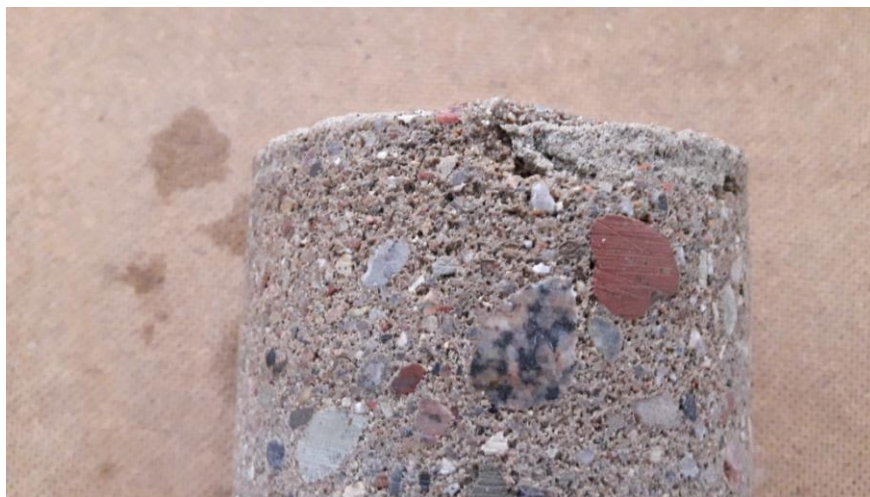
Fot.6: Struktura betonu skrajnych łuków
