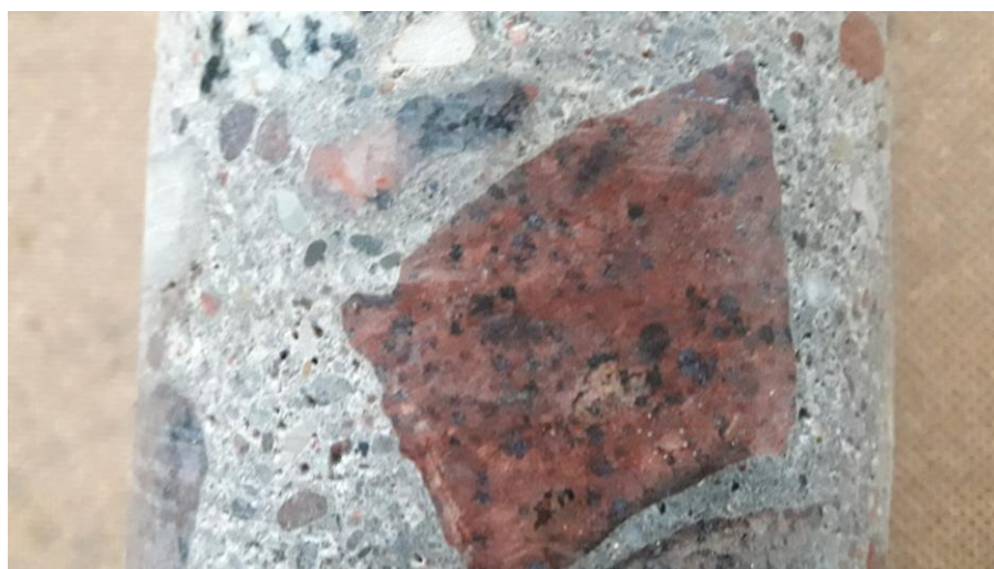
Fot.7: Struktura betonu łuku środkowego
