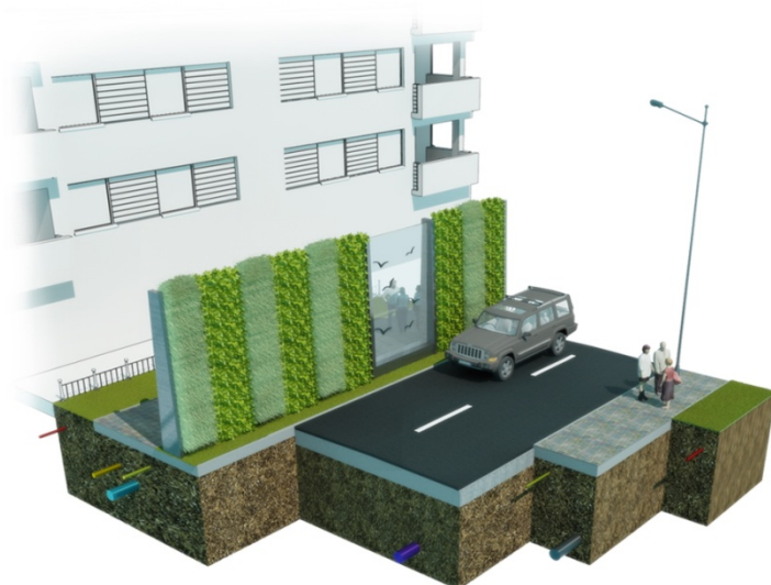
Ryc. 3. Roślinna ściana w formie gabionu
