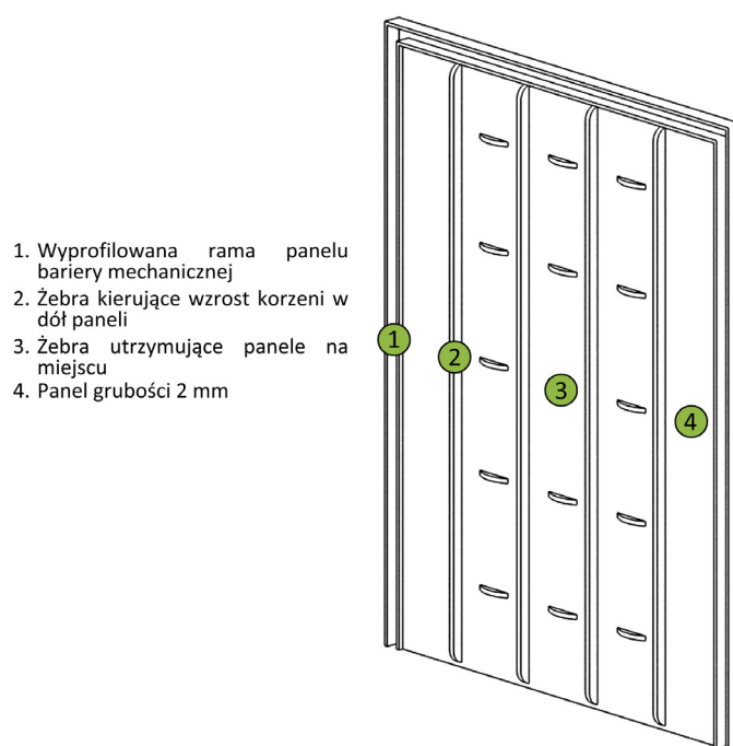
Ryc.14. Schemat pojedynczego panelu bariery mechanicznej (opracowanie własne na podstawie materiałów firmy DeepRoot)
