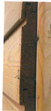
Fot. nr 3 i nr 4 Układy włókien w deskach: odrdzeniowa i dordzeniowa – oraz konsekwencje
