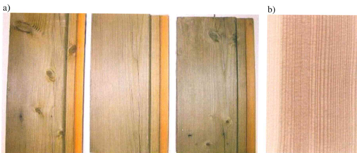
Fot.1. Dostarczone próbki drewna do badań identyfikacyjnych: a) z elementów elewacji, b) porównawczo z deski elewacyjnej z magazynu (przekrój promieniowy)
