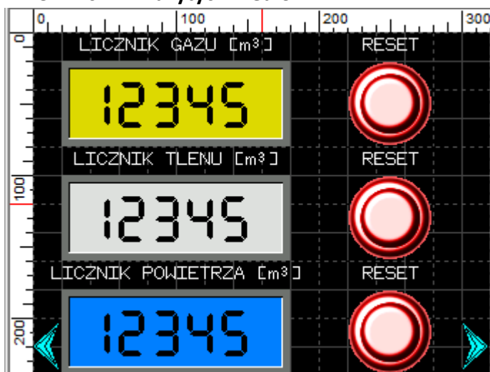
Rys.6 panel sumarycznych liczników zużytych mediów na cykl
