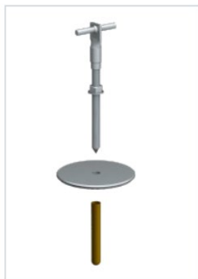
Rys. 10. Części wklejanej kotwy talerzowej przygotowane do montażu
