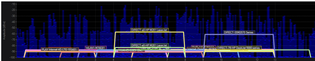
Rysunek 23: Pomiar widma w paśmie 2,4GHz z zaznaczonymi sieciami
