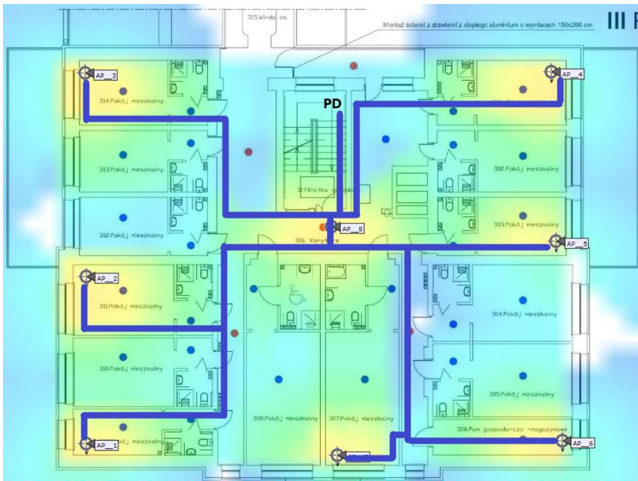
Rysunek 35: Całe okablowanie zejdzie się w korytkach do punktu PD, wzdłuż styku ścian/sufitu
