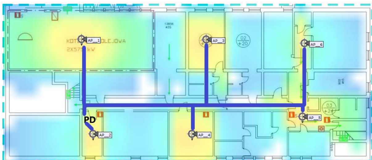
Rysunek 47: Całe okablowanie zejdzie się w korytkach do punktu PD, wzdłuż styku ścian/sufitu.
