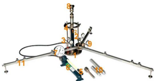
Rys. 1.1. Aparatura VSS z trzypunktowym pomiarem przemieszczenia płyty
