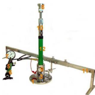
Rys. 1.2. Aparatura VSS z jednopunktowym pomiarem przemieszczenia płyty
