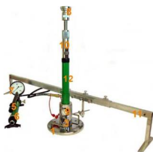
Rys. 1.2 Aparatura VSS z jednopunktowym pomiarem przemieszczenia płyty
