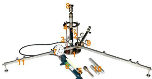
Rys. 1.1. Aparatura VSS z trzypunktowym pomiarem przemieszczenia płyty
