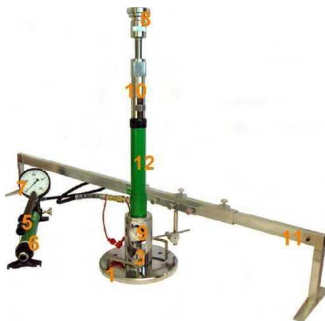
Rys. 1.1. Aparatura VSS z trzypunktowym pomiarem przemieszczenia płyty
