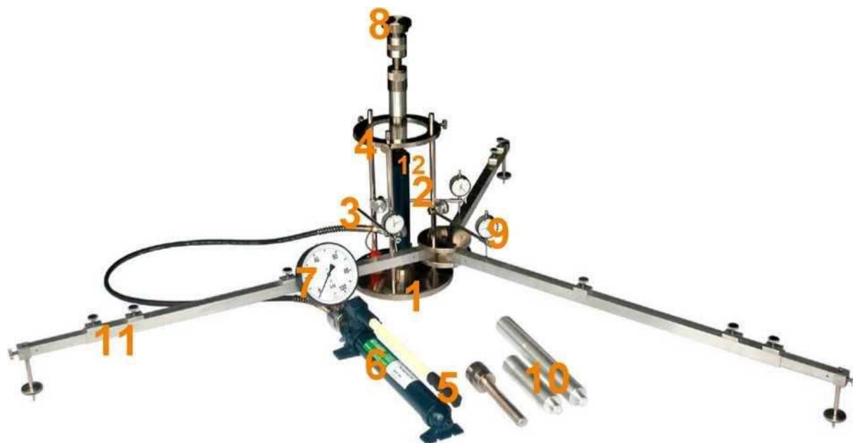
Rys. 1.1. Aparatura VSS z trzypunktowym pomiarem przemieszczenia płyty
