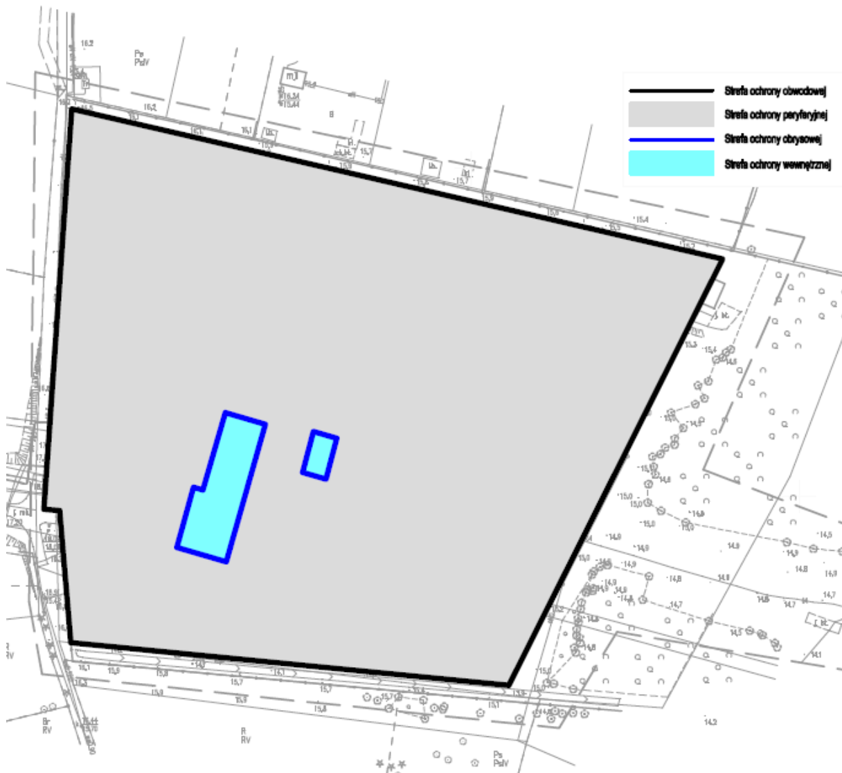
Rysunek - Zasada podziału obiektu na strefy dozoru i ochrony na przykładzie PW Żelewo
