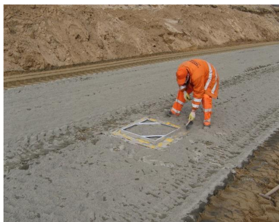
Wymiatanie z tacki pomiarowej spoiwa znajdującego się poza szablonem
