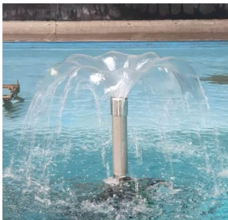
Obraz wodny o wysokości do 2m – 8 pionowych, smukłych strumieni wodnych w kształcie wulkanu:
