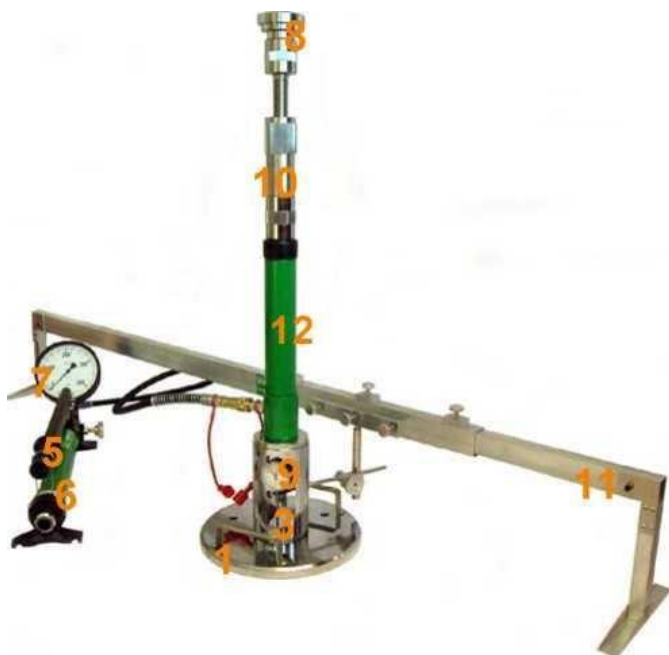
Rys. 1.2 Aparatura VSS z jednopunktowym pomiarem przemieszczenia płyty
