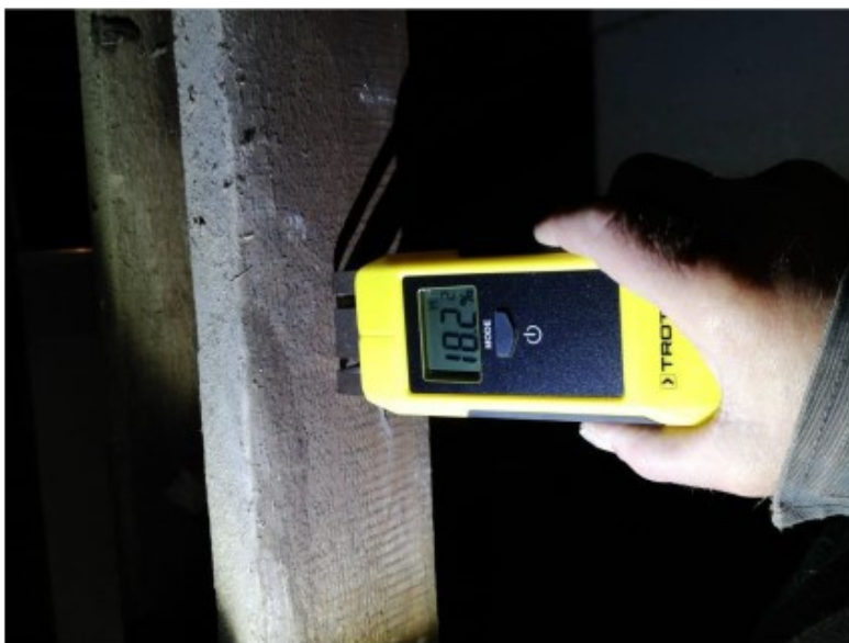
Fot. Nr 2. Badania wilgotnościowe drewna część C.
