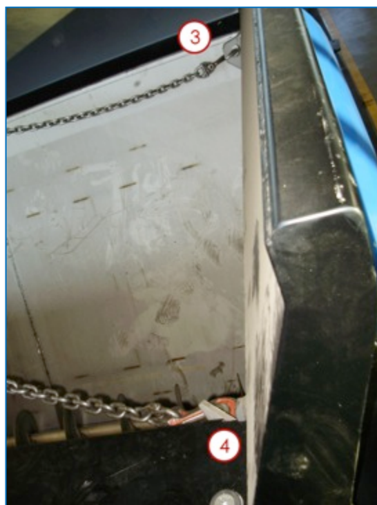
rys. 5-3: unoszenie maszyny (szczegółowy widok strony tylnej)
