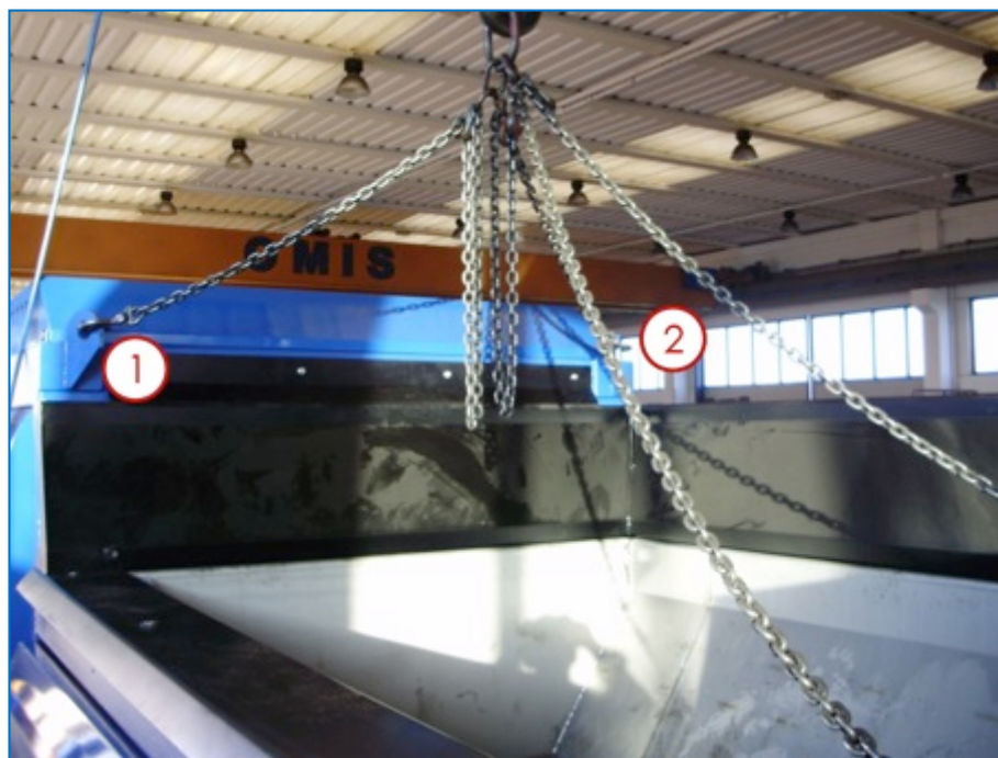
rys. 5-1: unoszenie maszyny (strona przednia)
