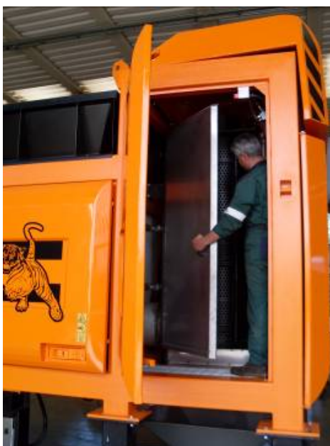
rys. 6-6: otwieranie osłony
