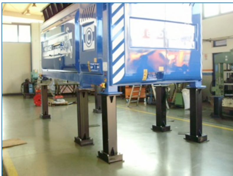
rys. 5-8: zmontowane nogi
