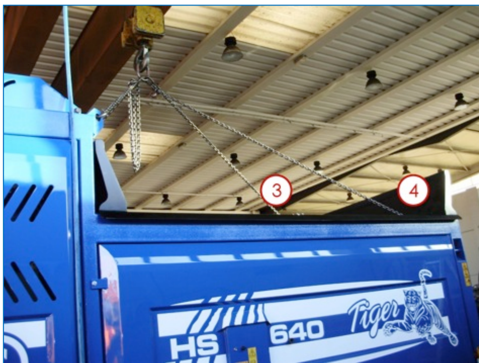
rys. 5-2: unoszenie maszyny (strona tylna)
