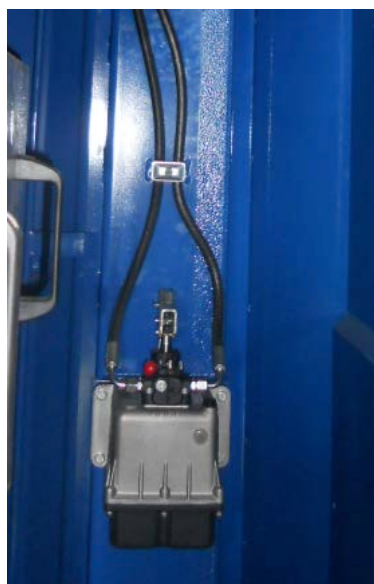
rys. 5-24: położenie pompy ręcznej
