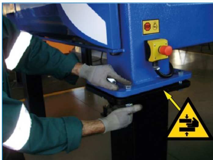
rys. 5-7: montaż nogi podporowej z maszyną
