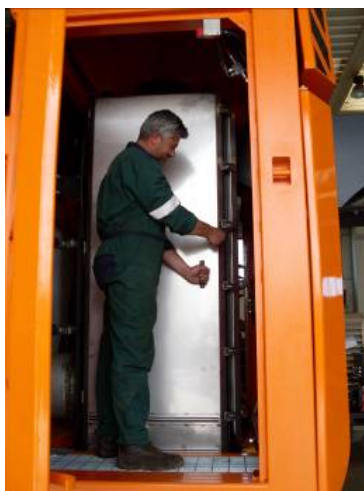
rys. 6-5: zdejmowanie osłon stałych
