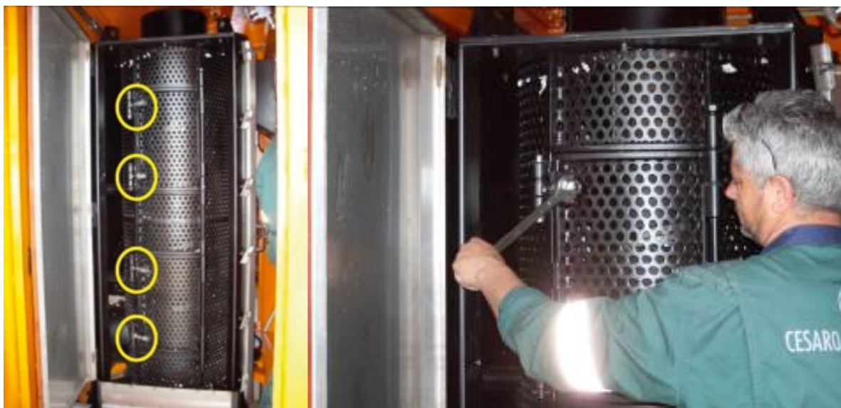
rys. 6-7: nakrętki kratki ochronnej
