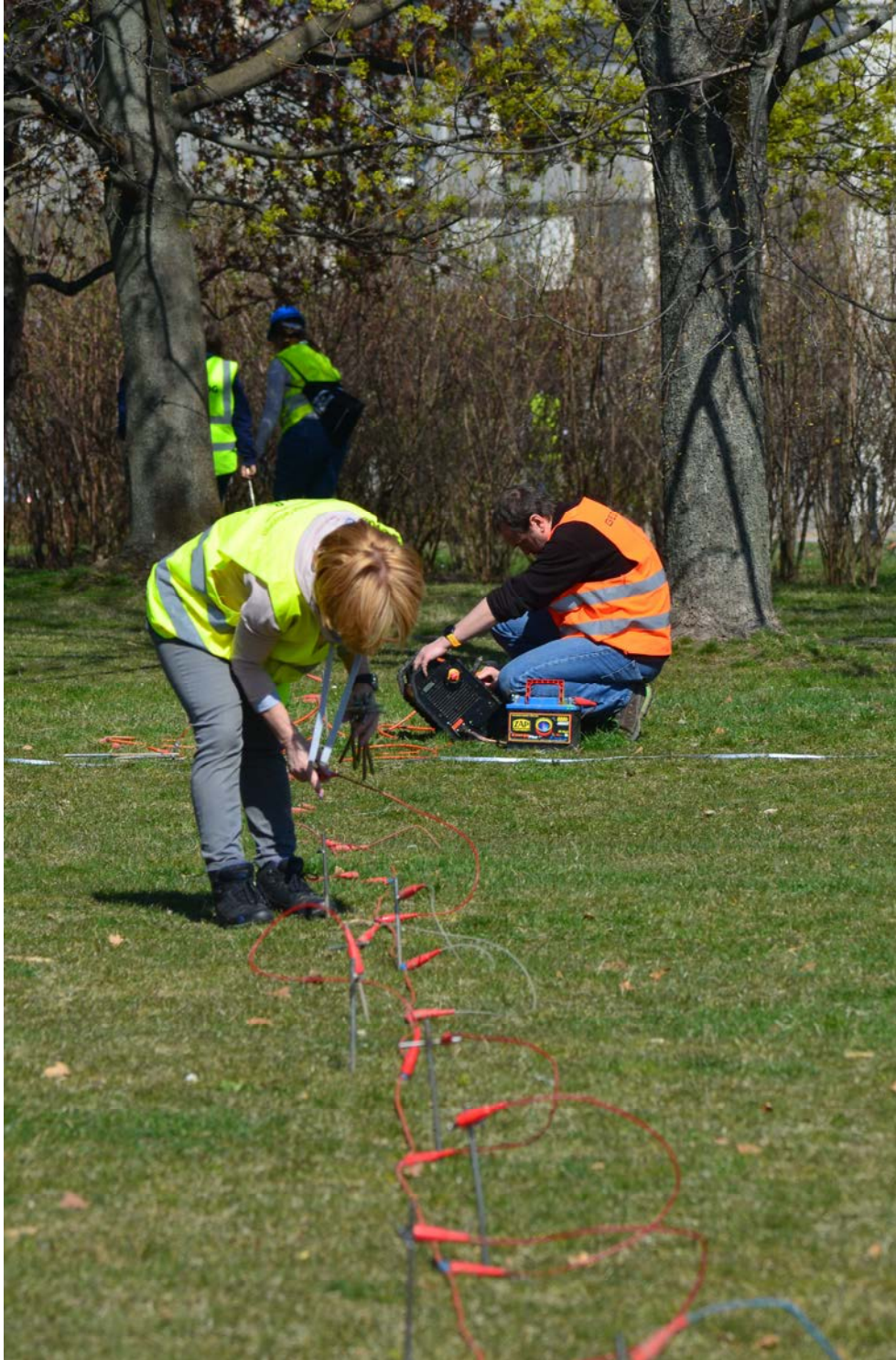
Zdjęcie 3 Pomiary metodą tomografii elektrooporowej prowadzone na obszarze projektowanej odbudowy Pałacu Brühla (mgr A. Wojdalska, prof. S Kowalczyk, studenci Wydziału Geologii UW)
