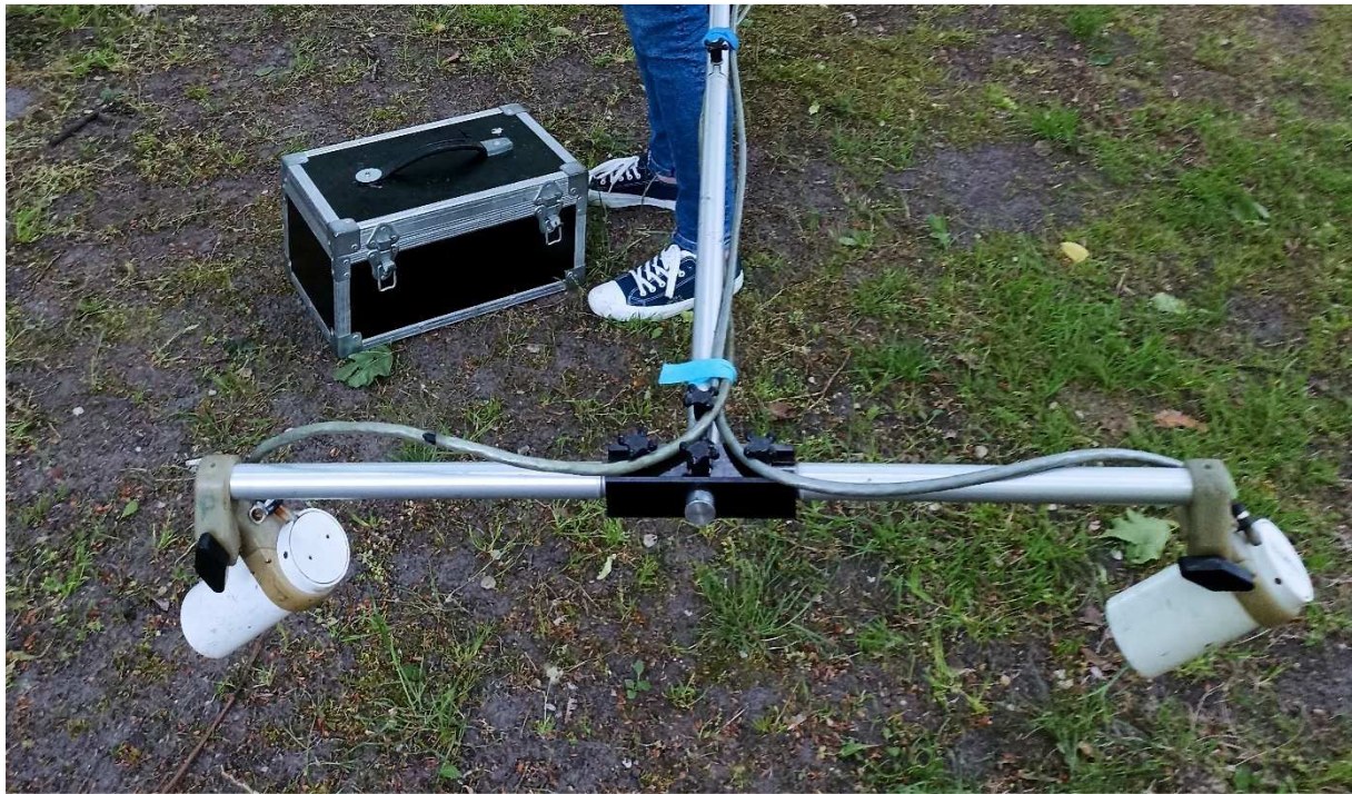
Zdjęcie 11. Sondy magnetometru G-858G Geometrics.
