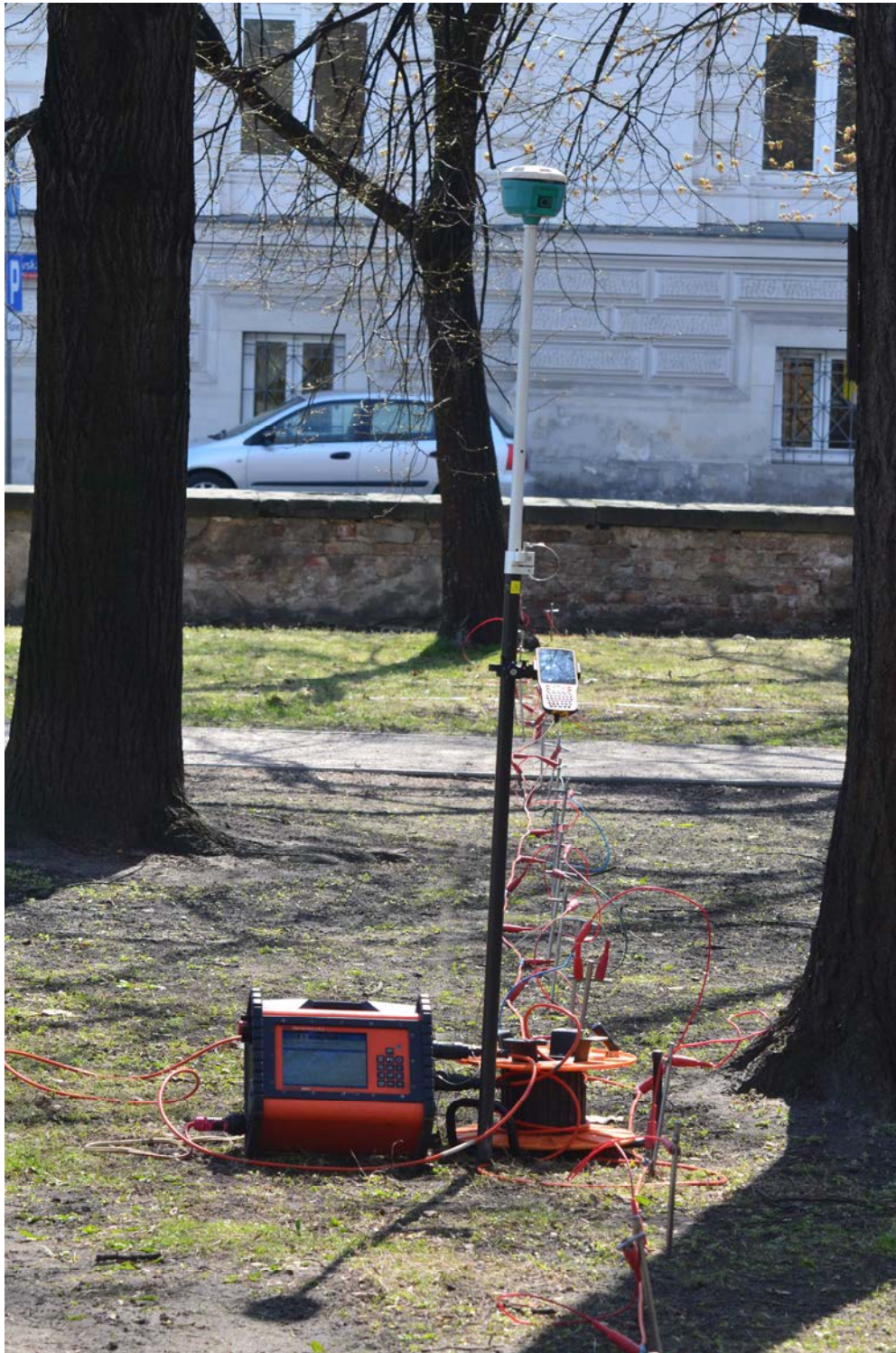
Zdjęcie 4 Pomiary metodą tomografii elektrooporowej prowadzone na obszarze projektowanej odbudowy kamienic przy ul. Królewskiej
