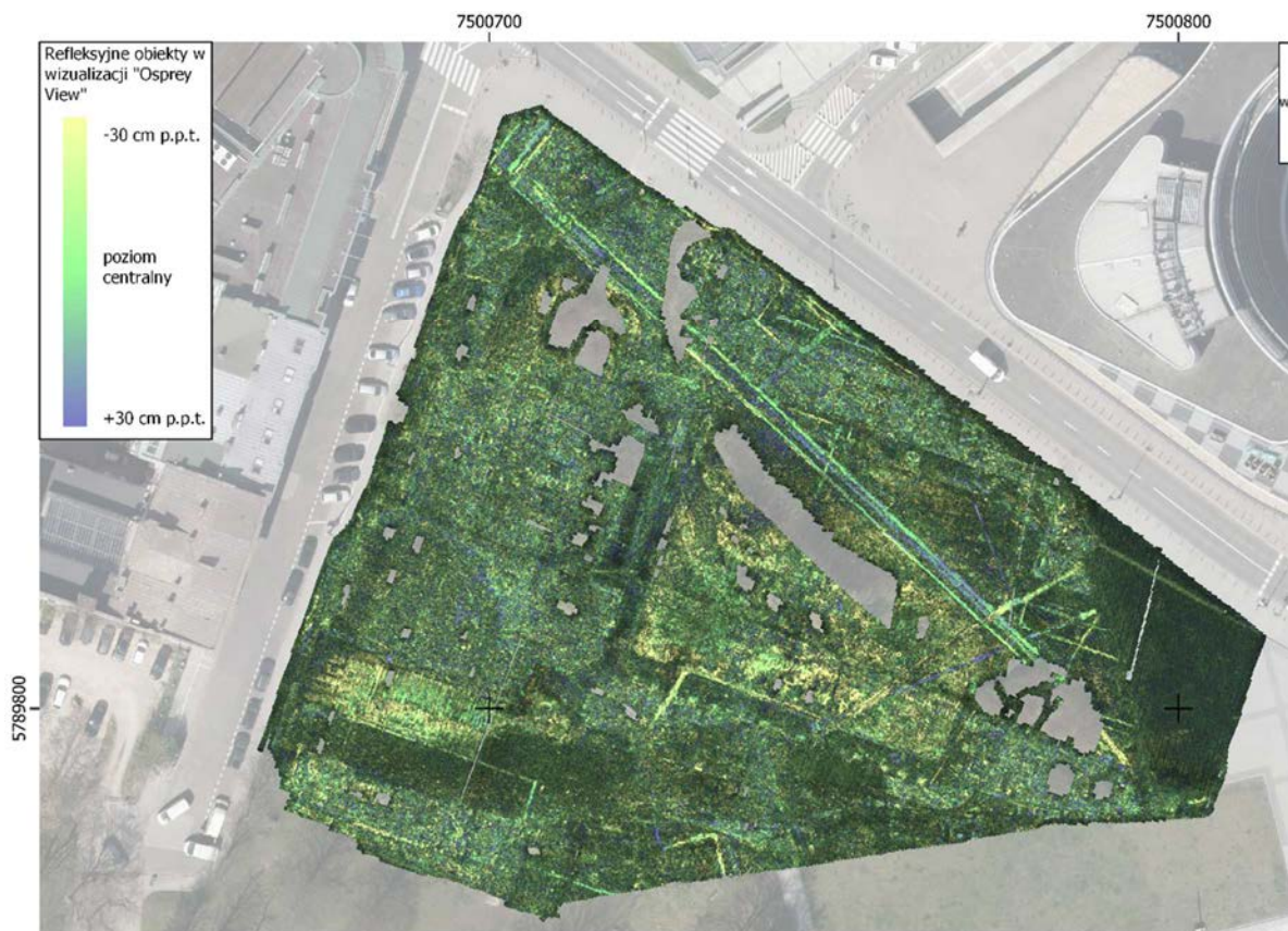
Fig. 11. Wizualizacja wyników pomiarów georadarowych na obszarze Pałacu Brühla w konwencji Osprey View, dla poziomu 1,1 m. pod poziomem terenu (p.p.t.).
