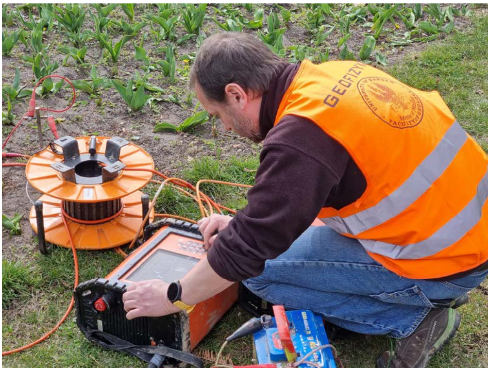
Zdjęcie 1 Pomiary metodą tomografii elektrooporowej prowadzone na obszarze projektowanej odbudowy Pałacu Brühla prof. S Kowalczyk)
