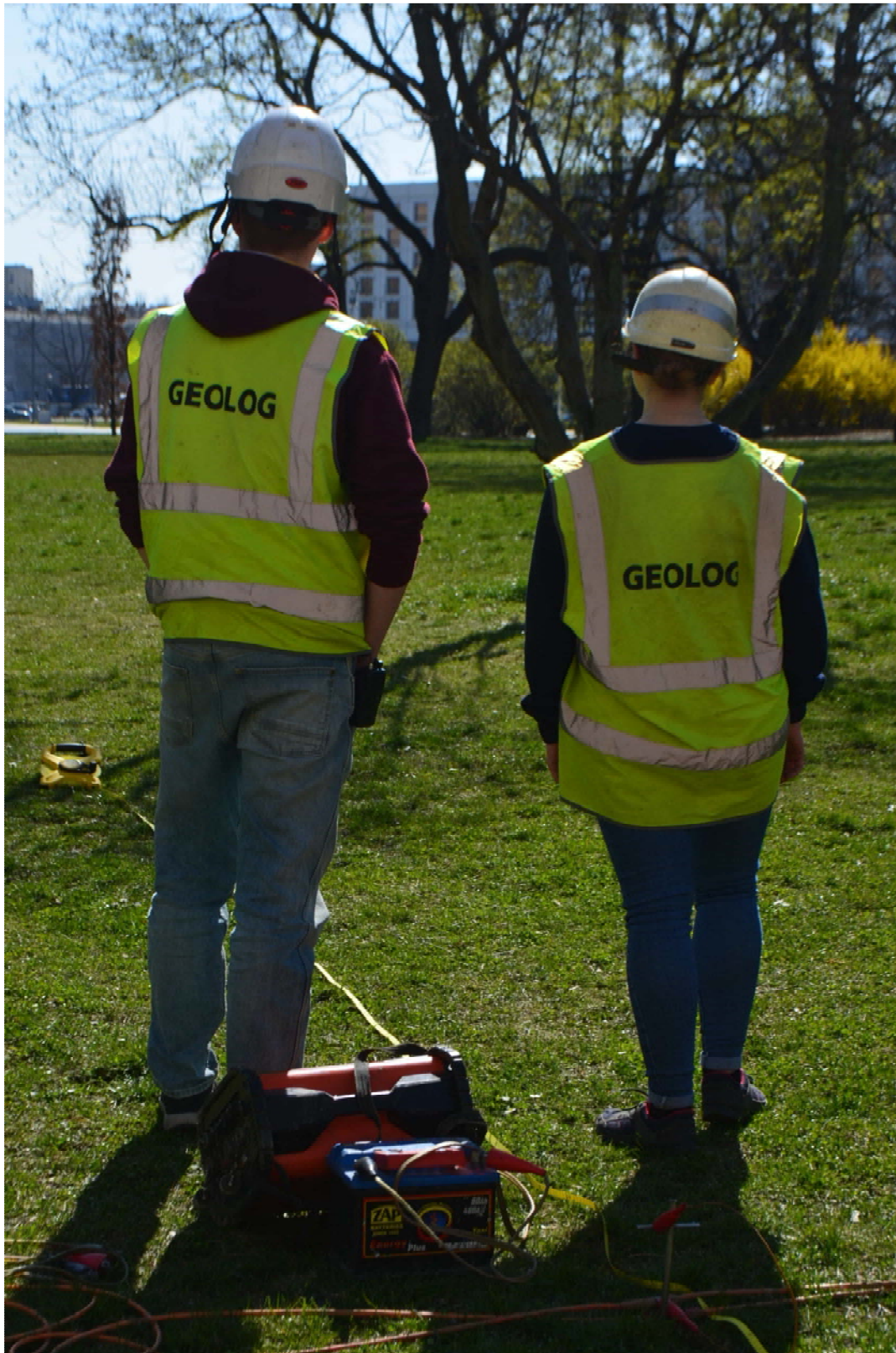
Zdjęcie 9. Pomiary ERT – obszar Pałacu Brühla (st. technik S. Mieszkowski, technik A. Mucha)
