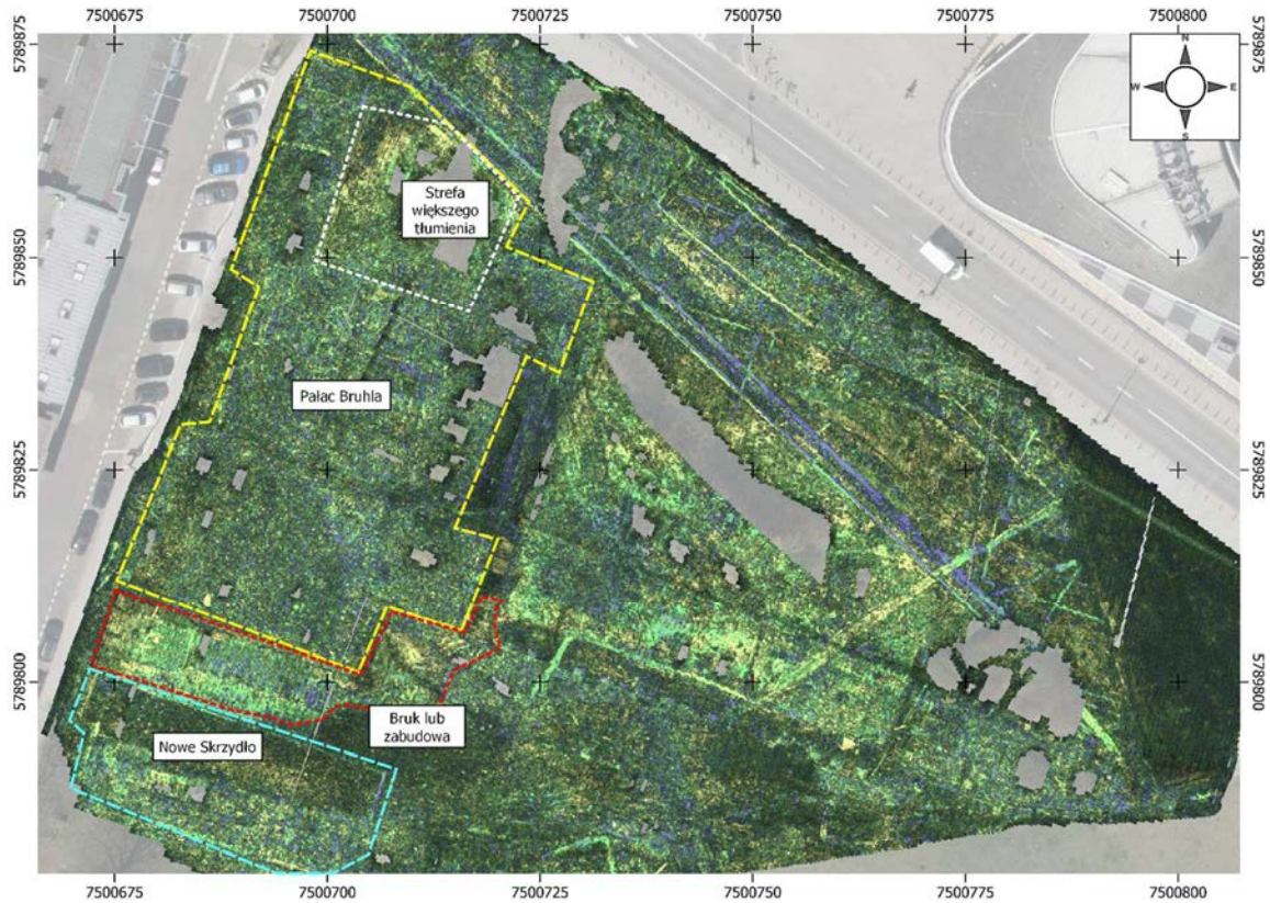
Fig. 19. Interpretacja anomalii na obszarze Pałacu Brühla na tle wybrane mapy anomalii georadarowych.
