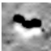
Fig. 9. Przykładowa anomalia magnetyczna z wyraźnie zaznaczoną strukturą biegunową (dipolową). Widoczne bieguny min/max wartości w pobliżu obiektu lub obiektów będących źródłem anomalii.
