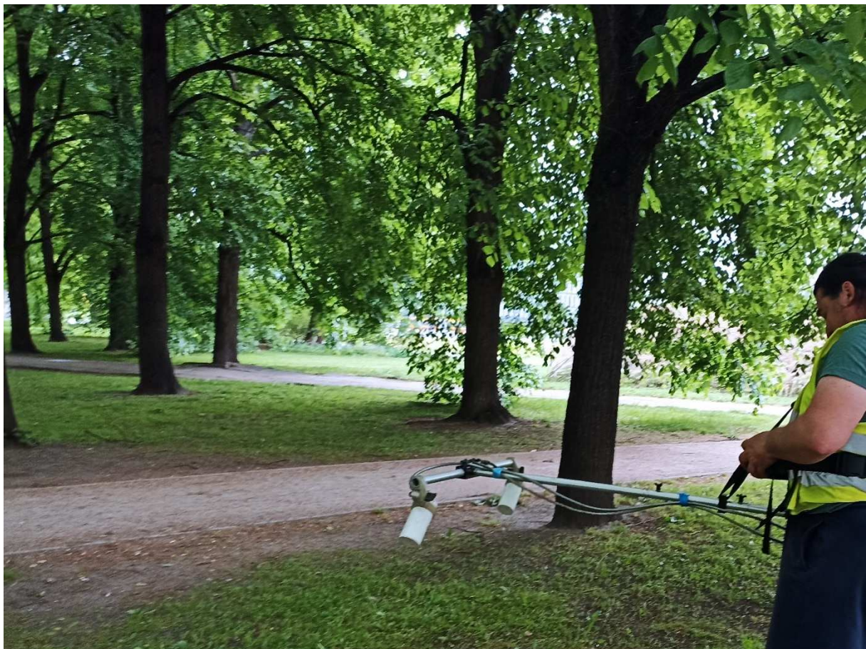
Zdjęcie 12. Pomiary magnetyczne – magnetometr G-858G Geometrics (mgr W. Małkowski).
