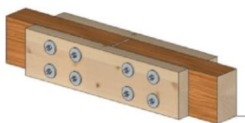
Schemat 1 - Poprawne wzmocnienie elementu drewnianego za pomocą obustronnych nakładek skręconych
