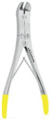
09-595 180 mm (7 1/8") 09-596 210 mm (8 1/4") kleszcze do cięcia drutu /Drahtschneidezangen/wire cutters Do drutów: miękki max. 3,0 mm twardy max. 2,5 mm Für Draht: Weich max. 3,0 mm Hard max. 2,5 mm For wires: Soft max. 3,0 mm Hard max. 2,5 mm
