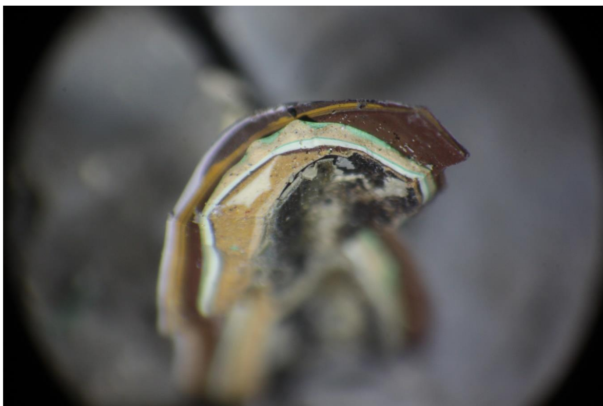
FOT. 82 - Mikroskopowy obraz przekroju próbki powłok malarskich z pochwytu balustrady schodów pomocniczej klatki schodowej.
