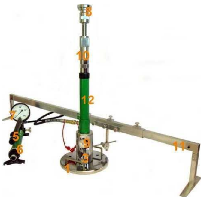
Rys. 1.2 Aparatura VSS z jednopunktowym pomiarem przemieszczenia płyty
