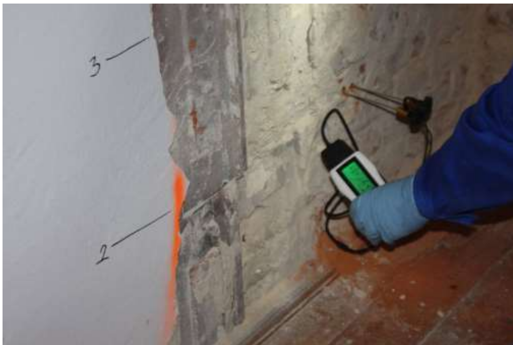
Pomiary wilgotności ścian
