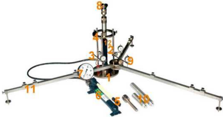
Rys. 1.1. Aparatura VSS z trzypunktowym pomiarem przemieszczenia płyty
