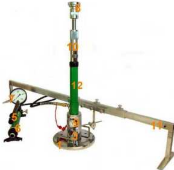
Rys. 1.2 Aparatura VSS z jednopunktowym pomiarem przemieszczenia płyty
