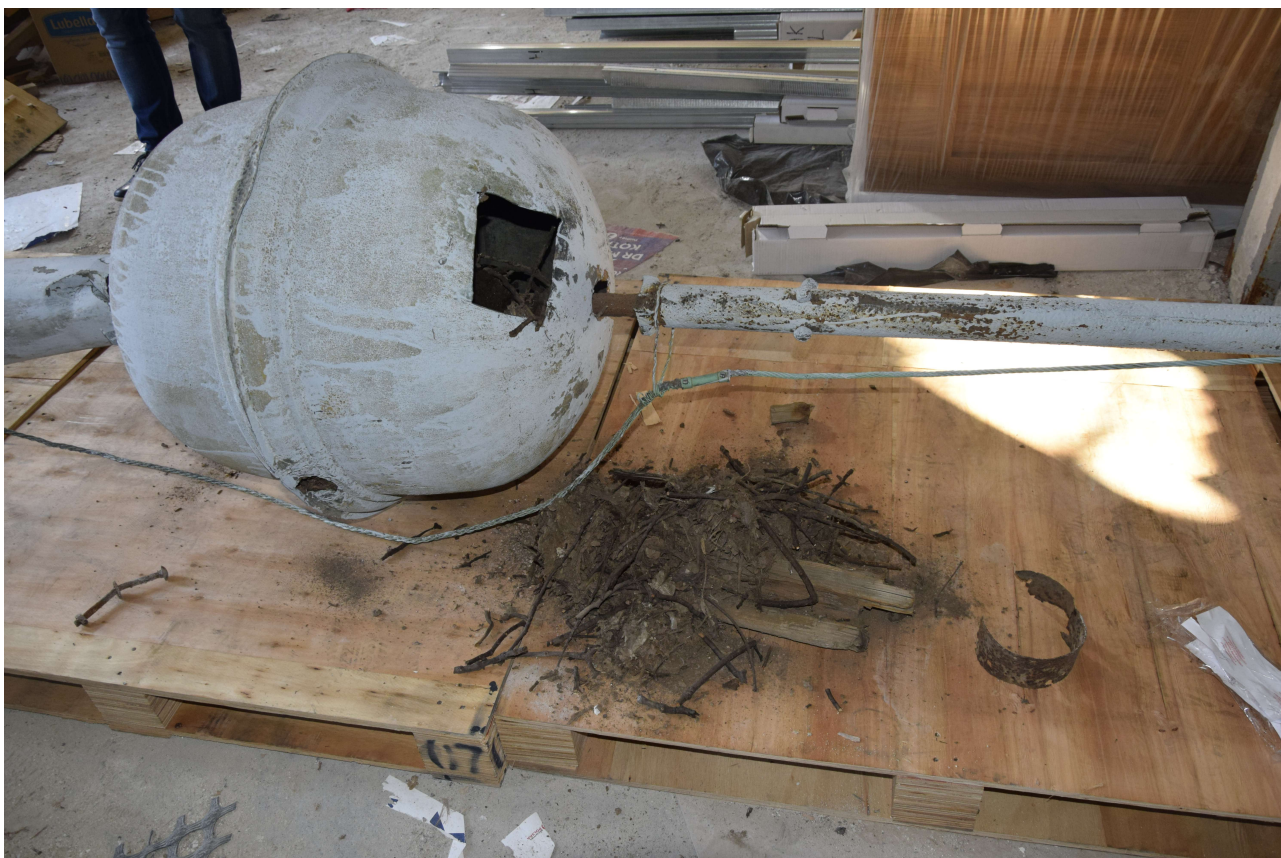
Fot. 19. Zdemontowana uszkodzona iglica
