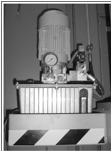
Ilustracja 4-4: Widok agregatu hydraulicznego.
