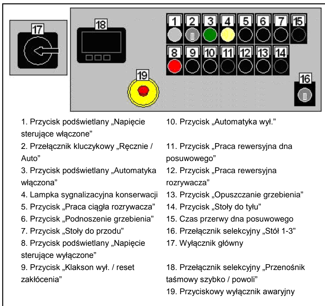
Ilustracja 6-1: Elementy obsługi na szafie sterowniczej maszyny.
