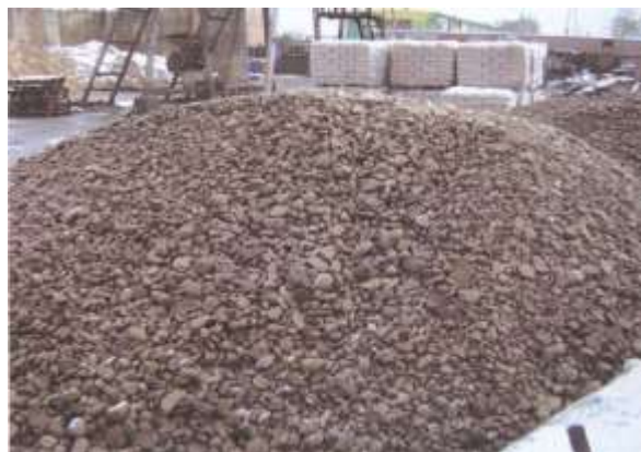
Zmieszany materiał żwirowo-kamienny różnych frakcji przygotowany na tarlisko Źródło: J.Nyk, J.Domagała „Sztuczne tarliska dla ryb...” w „Użytkownik rybacki nowa rzeczywistość” Spała 2008 r.
