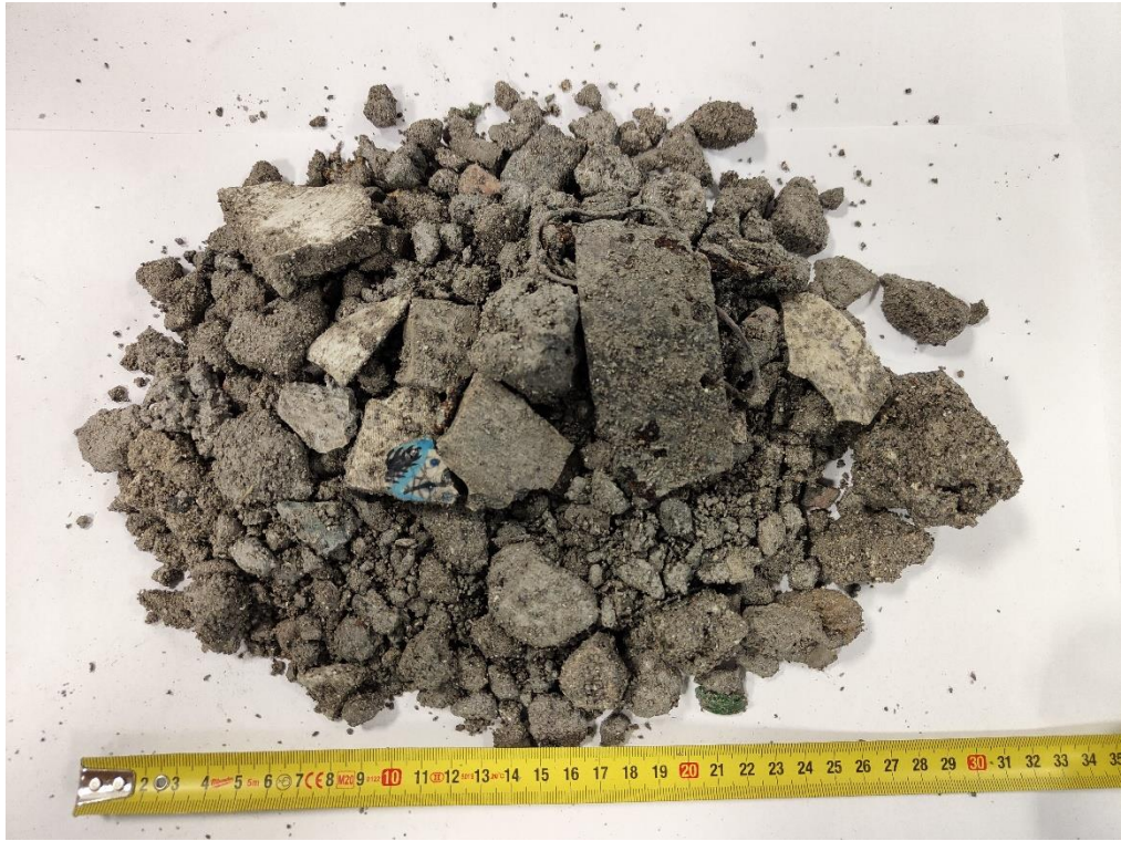
Rysunek 3.12 Przykładowe zdjęcie żużli występujących w formie spieków - przykład nr 4
