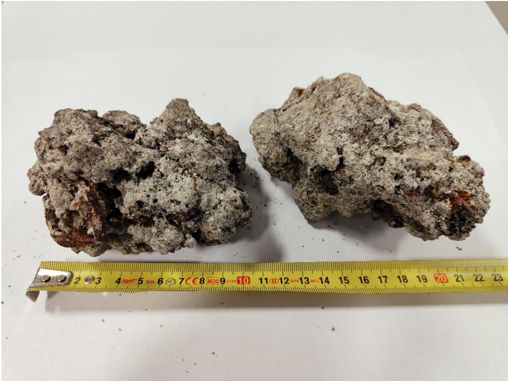
Rysunek 3.9 Przykładowe zdjęcie żużli występujących w formie spieków - przykład nr 1
