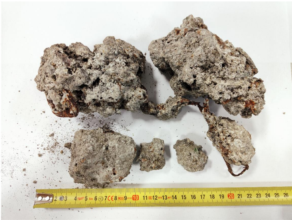
Rysunek 3.10 Przykładowe zdjęcie żużli występujących w formie spieków - przykład nr 2
