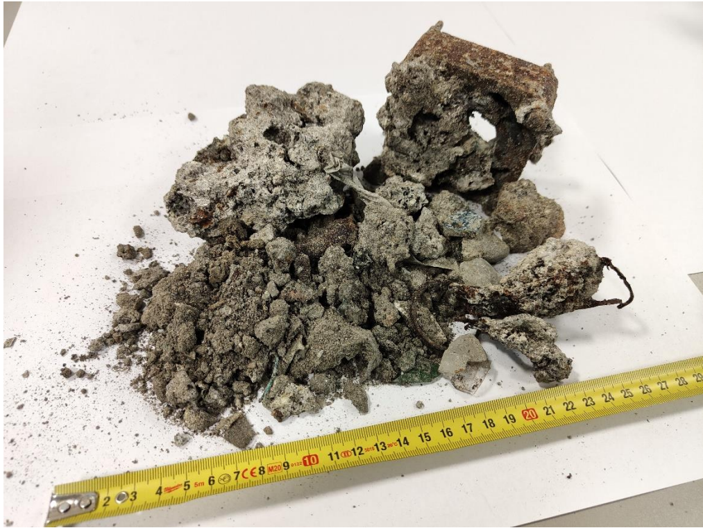
Rysunek 3.11 Przykładowe zdjęcie żużli występujących w formie spieków - przykład nr 3
