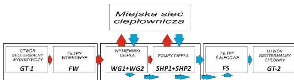
ryc. 19 Ciąg technologiczny ciepłowni geotermalnej
