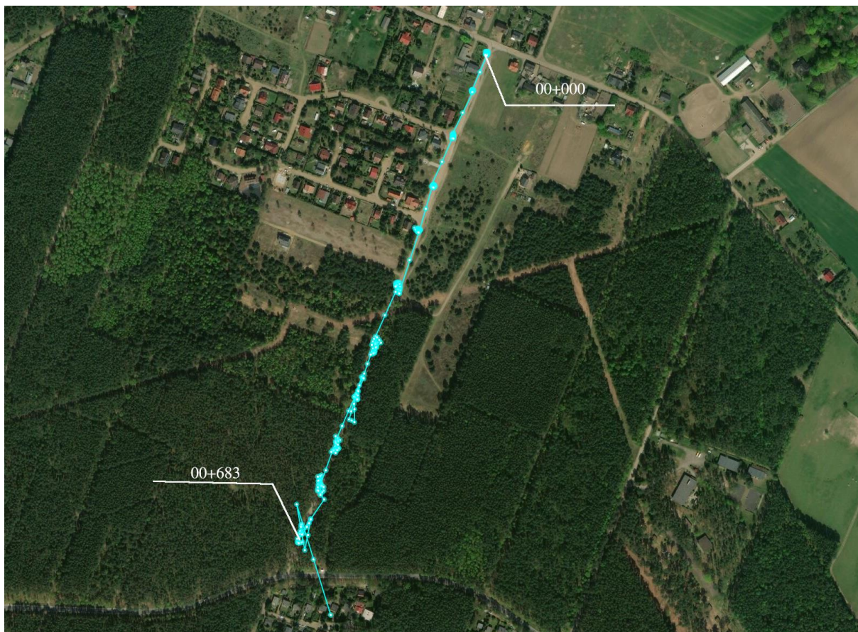
Rys. 7 Lokalizacja miejsc, w których wykonane zostały badania nośności nawierzchni jezdni ( uwaga: na miejsca badań nośności nawierzchni wskazuje na rysunku co drugi punkt )
