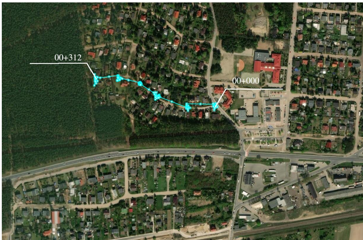
Rys. 20 Lokalizacja miejsc, w których wykonane zostały badania nośności nawierzchni jezdni ( uwaga: na miejsca badań nośności nawierzchni wskazuje na rysunku co drugi punkt )
