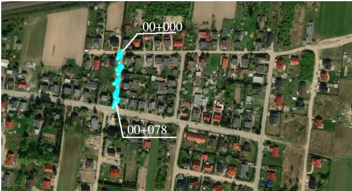
Rys. 10 Lokalizacja miejsc, w których wykonane zostały badania nośności nawierzchni jezdni ( uwaga: na miejsca badań nośności nawierzchni wskazuje na rysunku co drugi punkt )
