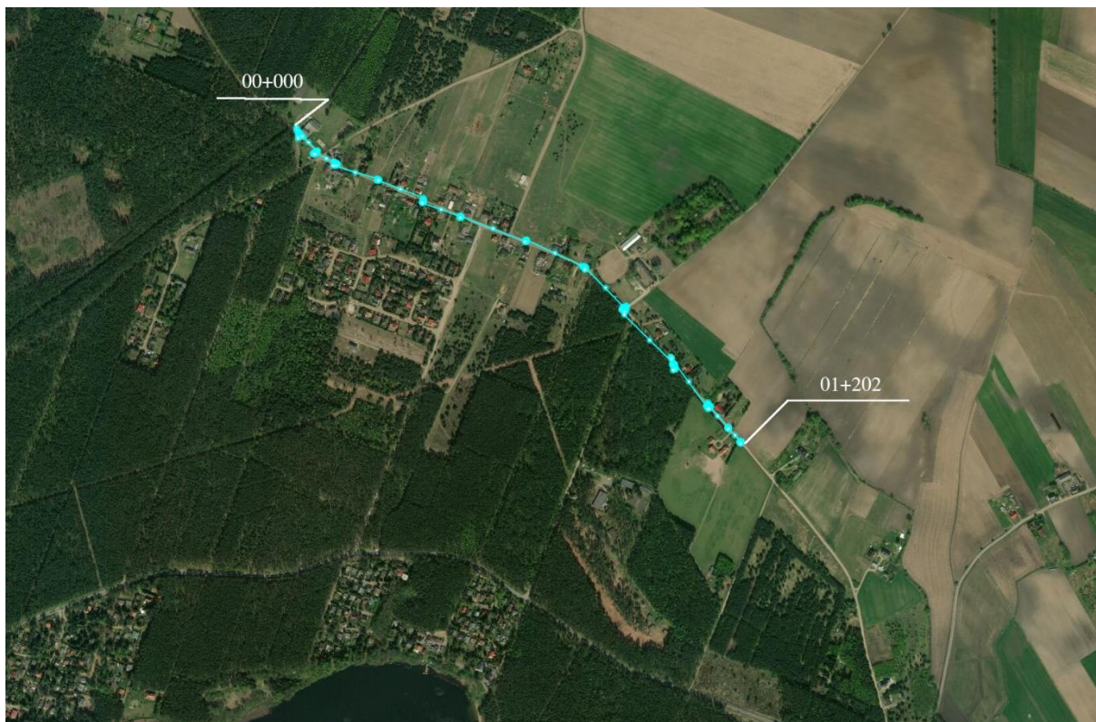
Rys. 8 Lokalizacja miejsc, w których wykonane zostały badania nośności nawierzchni jezdni ( uwaga: na miejsca badań nośności nawierzchni wskazuje na rysunku co drugi punkt )
