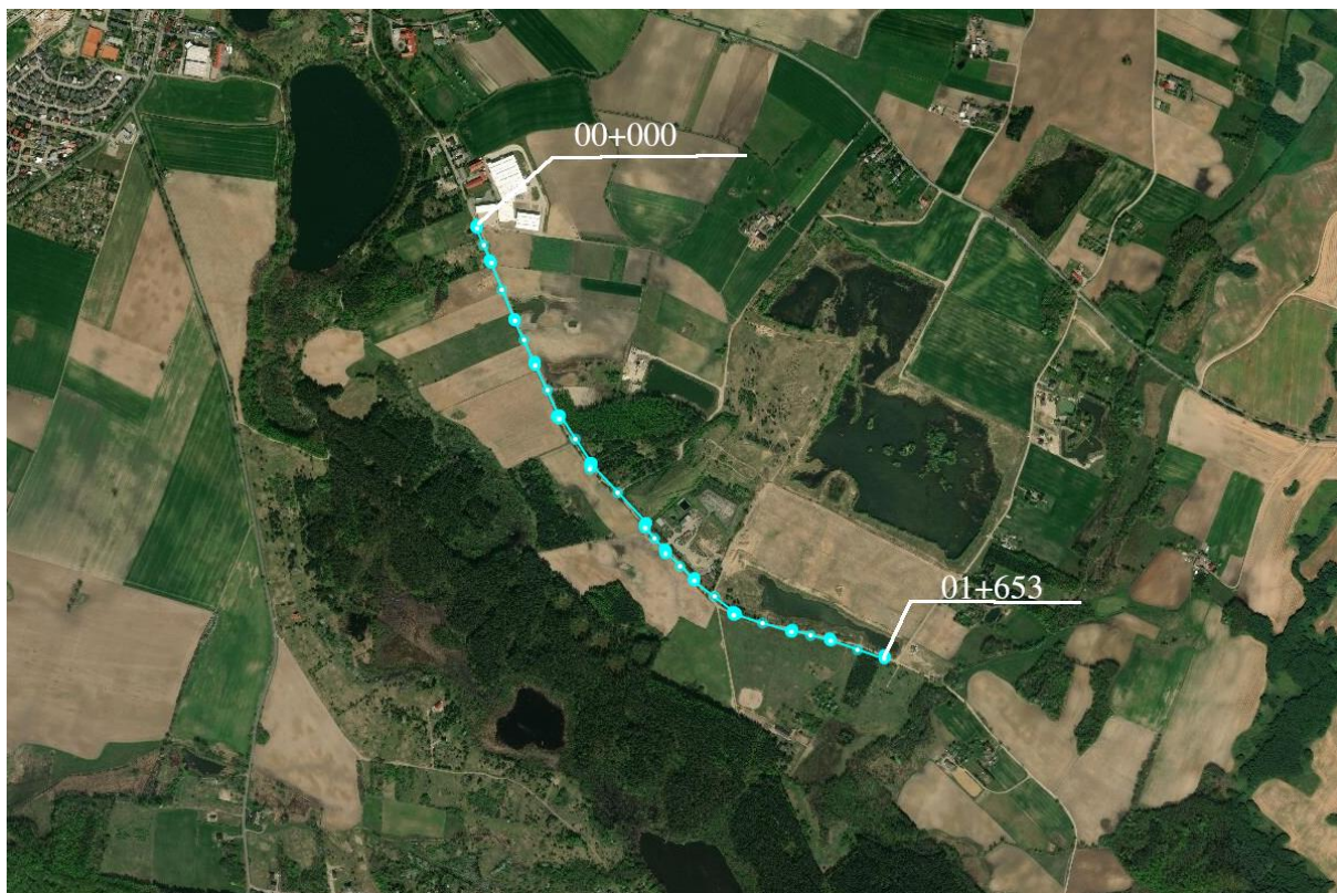
Rys. 17 Lokalizacja miejsc, w których wykonane zostały badania nośności nawierzchni jezdni ( uwaga: na miejsca badań nośności nawierzchni wskazuje na rysunku co drugi punkt )
