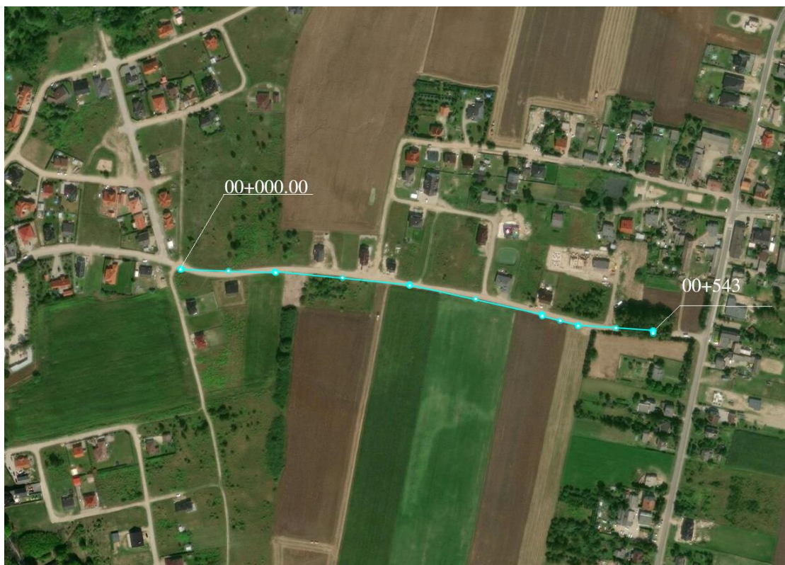
Rys. 1 Lokalizacja miejsc, w których wykonane zostały badania nośności nawierzchni jezdni ( uwaga: na miejsca badań nośności nawierzchni wskazuje na rysunku co drugi punkt )
