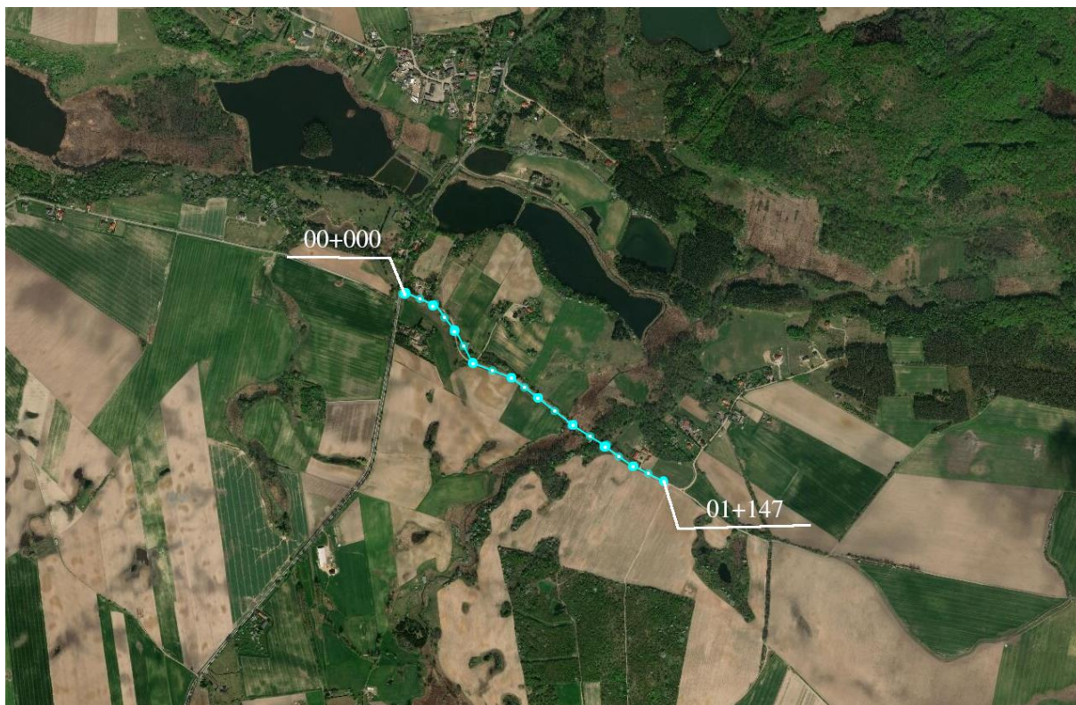
Rys. 22 Lokalizacja miejsc, w których wykonane zostały badania nośności nawierzchni jezdni ( uwaga: na miejsca badań nośności nawierzchni wskazuje na rysunku co drugi punkt )
