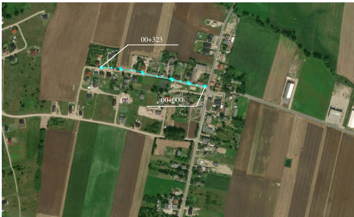
Rys. 19 Lokalizacja miejsc, w których wykonane zostały badania nośności nawierzchni jezdni ( uwaga: na miejsca badań nośności nawierzchni wskazuje na rysunku co drugi punkt )
