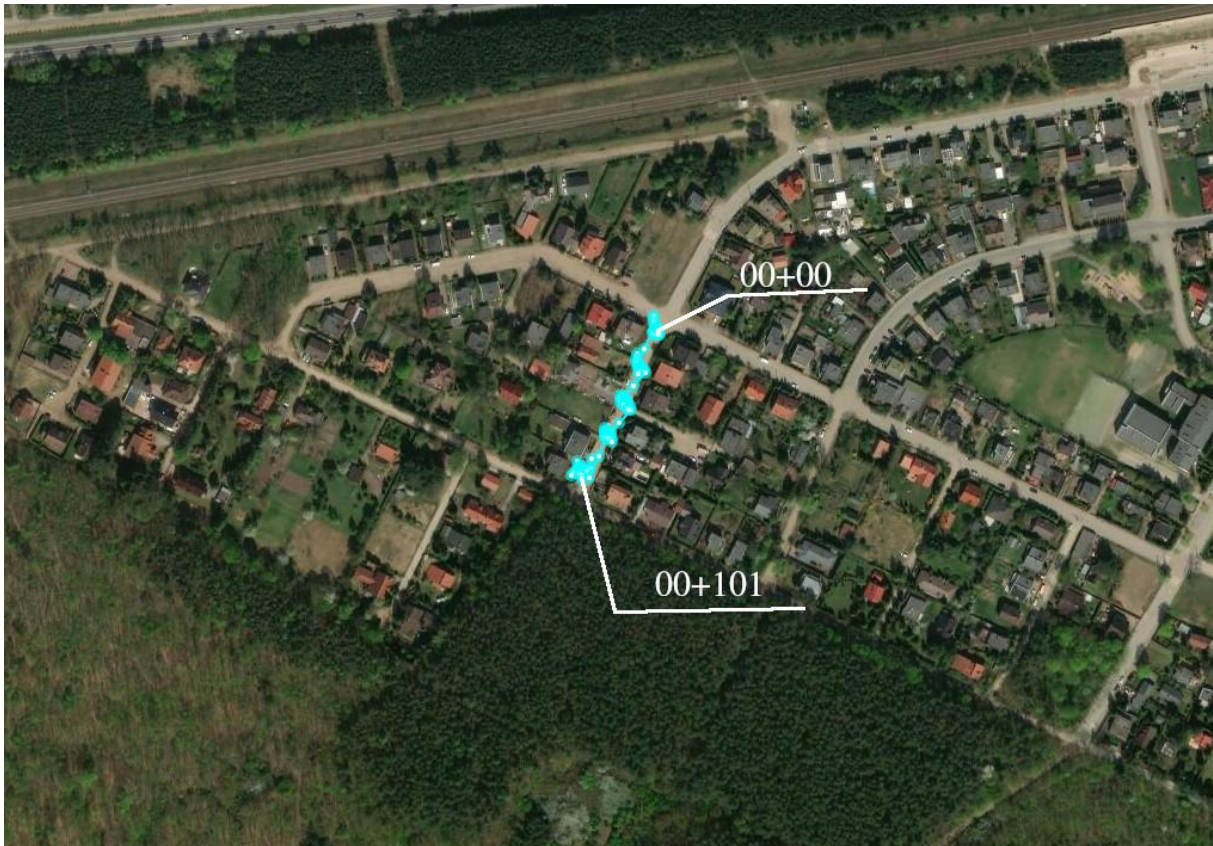
Rys. 15 Lokalizacja miejsc, w których wykonane zostały badania nośności nawierzchni jezdni ( uwaga: na miejsca badań nośności nawierzchni wskazuje na rysunku co drugi punkt )
