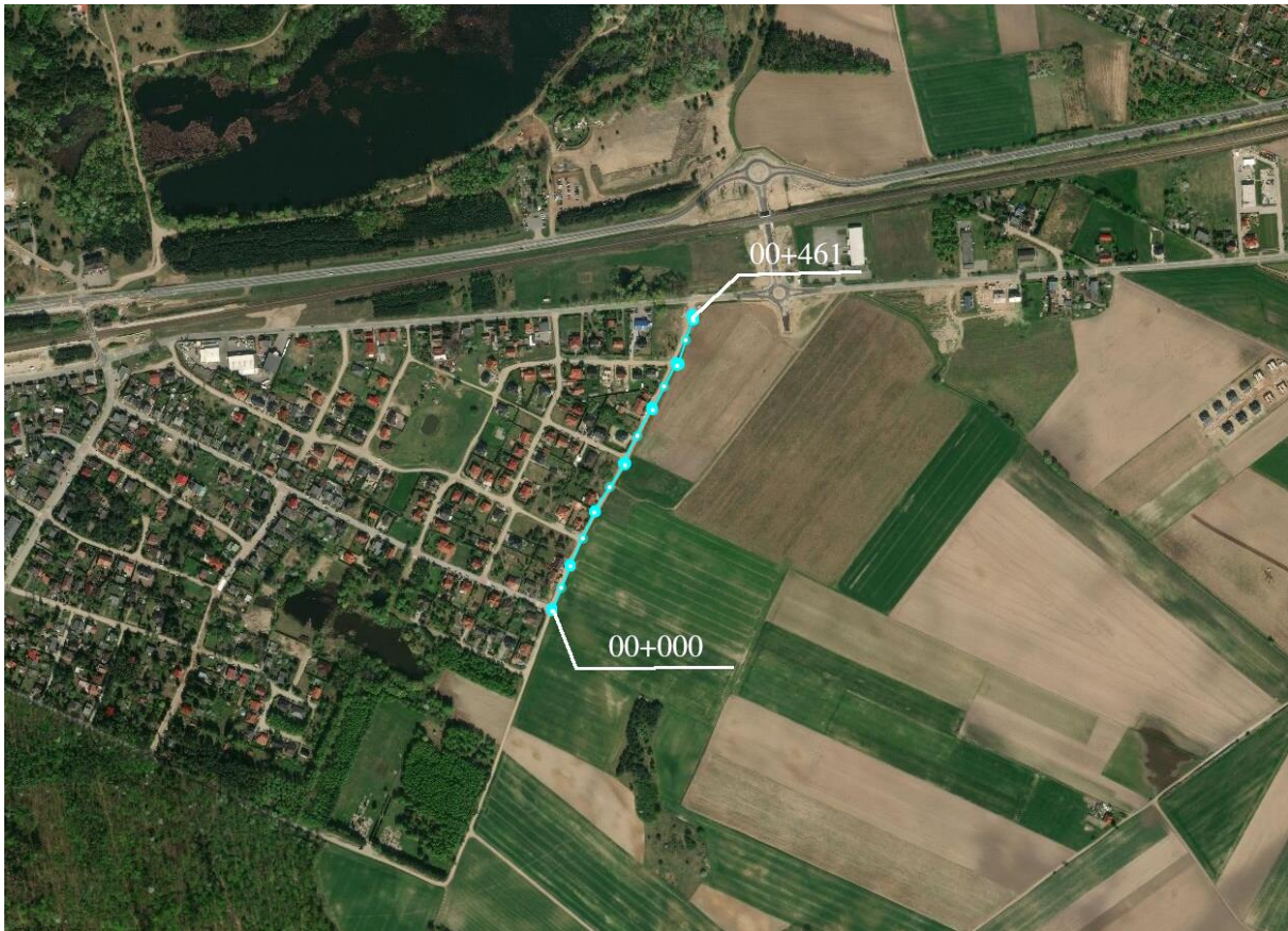
Rys. 20 Lokalizacja miejsc, w których wykonane zostały badania nośności nawierzchni jezdni ( uwaga: na miejsca badań nośności nawierzchni wskazuje na rysunku co drugi punkt )
