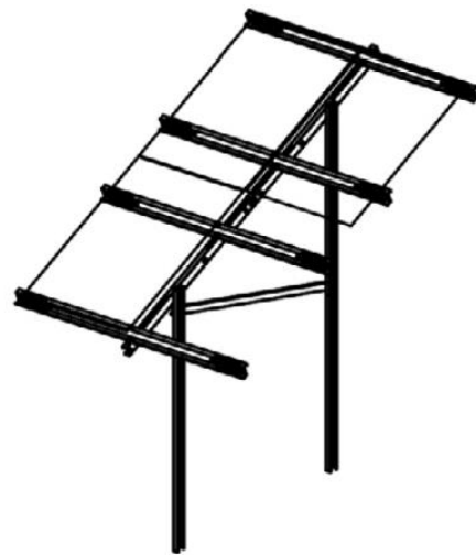
Rys 2a Przykładowy szkic dwupodporowego systemu mocowania modułów fotowoltaicznych przeznaczony do instalacji gruntowych. Mocowania modułów wertykalnie (krótszą krawędzią do dołu).
