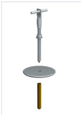
Rys. 10. Części wklejanej kotwy talerzowej przygotowane do montażu
