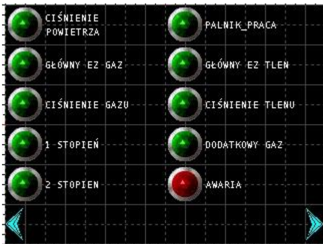
Rys.2 panel diagnostyczny z kontrolkami
